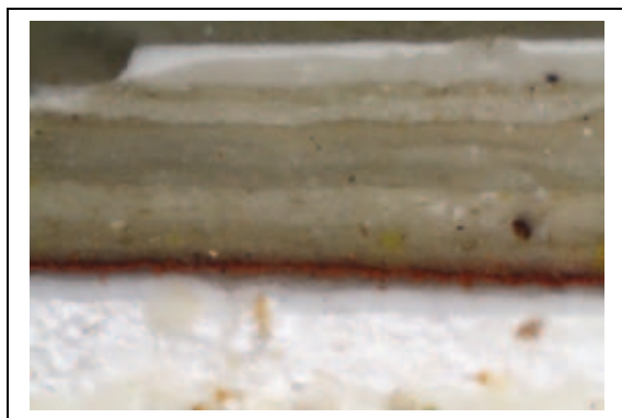
Obr. č. 23: Bílé dopadající světlo, fotografováno při zvětšení mikroskopu 50x-detail vrstev.
