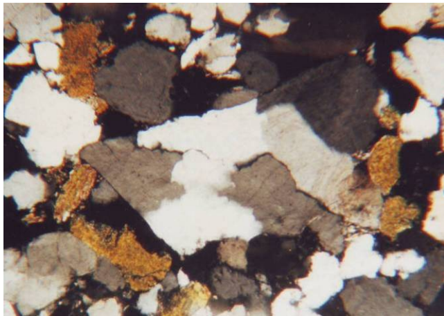
Obr. 6 Křemičitý pískovec, středně až jemnozrnný, glaukonitický Vzorek Ltm – 3, zvětšeno 32x, nikoly X,
