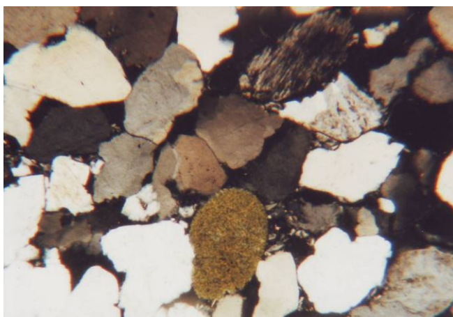
Obr. 4 Křemičitý pískovec, středně až hrubozrnný Vzorek Ltm – 1, zvětšeno 32x, nikoly X
