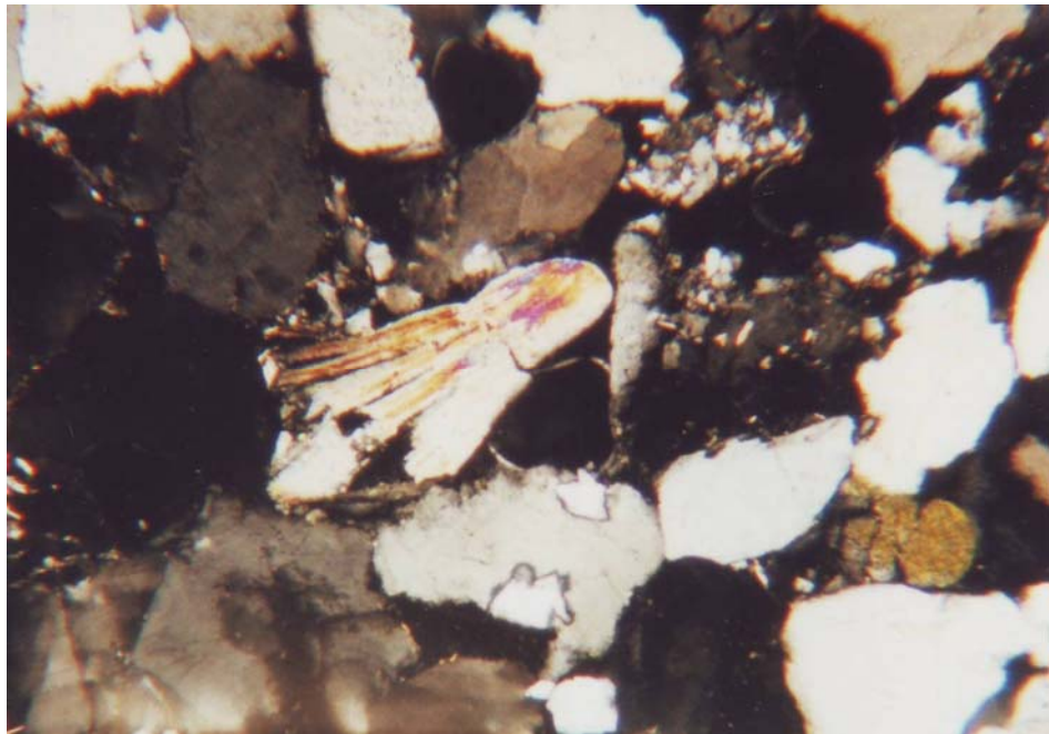
Pískovec křemenný, středně až hrubozrnný, silicifikovaný vzorek Ltm – 1, zvětšeno 32x, nikoly X struktura: přítomnost mechanicky poškozeného muskovitu
