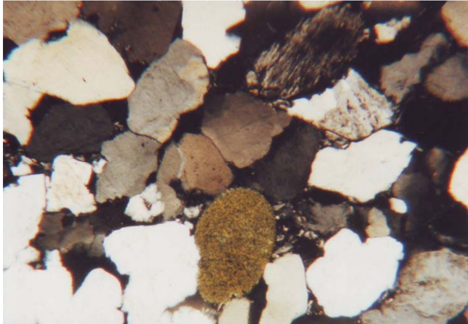
Pískovec křemenný, středně až hrubozrnný, silicifikovaný vzorek Ltm – 1, zvětšeno 32x, nikoly X struktura: srůsty křemenných klastů, opracování klastů, glaukonit, živce
