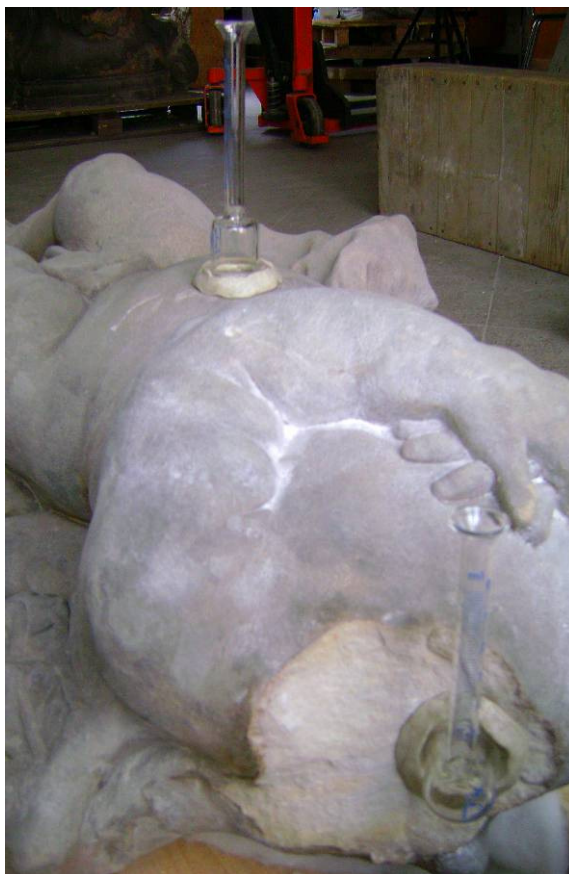
Obrázek 19: Restaurátorský průzkum – měření nasákavosti
