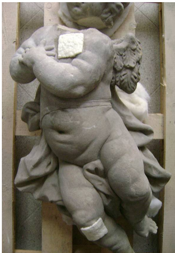
Obrázek 20: Odběry vzorků na vodorozpustné sole do buničiny
