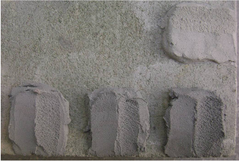
Obrázek 25: Část zkoušek plastických retuší, restaurátorský průzkum
