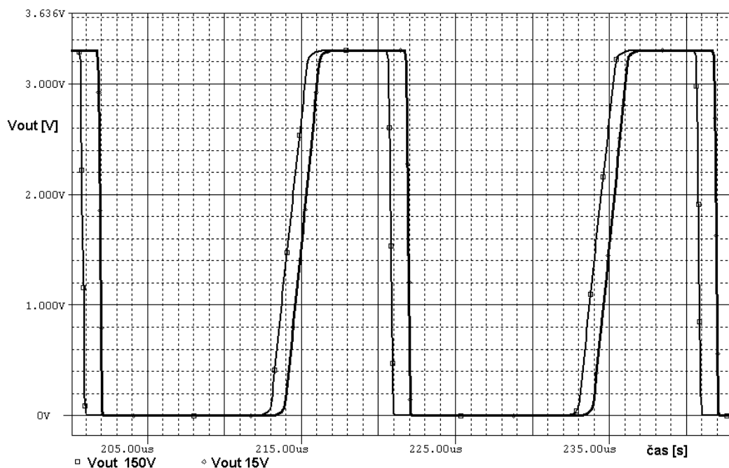
Obr. 3.6 Napětí na výstupu OZ pro vstupní přepětí 1kV
