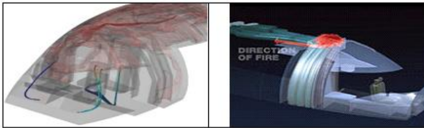
Obrázek 11 – Rekonstrukce šíření požáru letu Swissair 111 [43]; [44]
