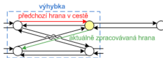
Obr. 4.19: Zpracování zakázaného odbočení na výhybce (Zdroj: vlastní)
