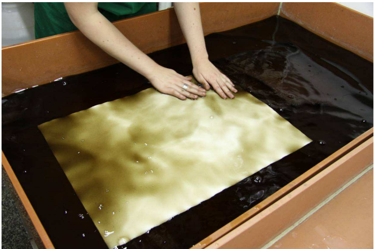
obr. č. 42 Tónování ručních papírů
