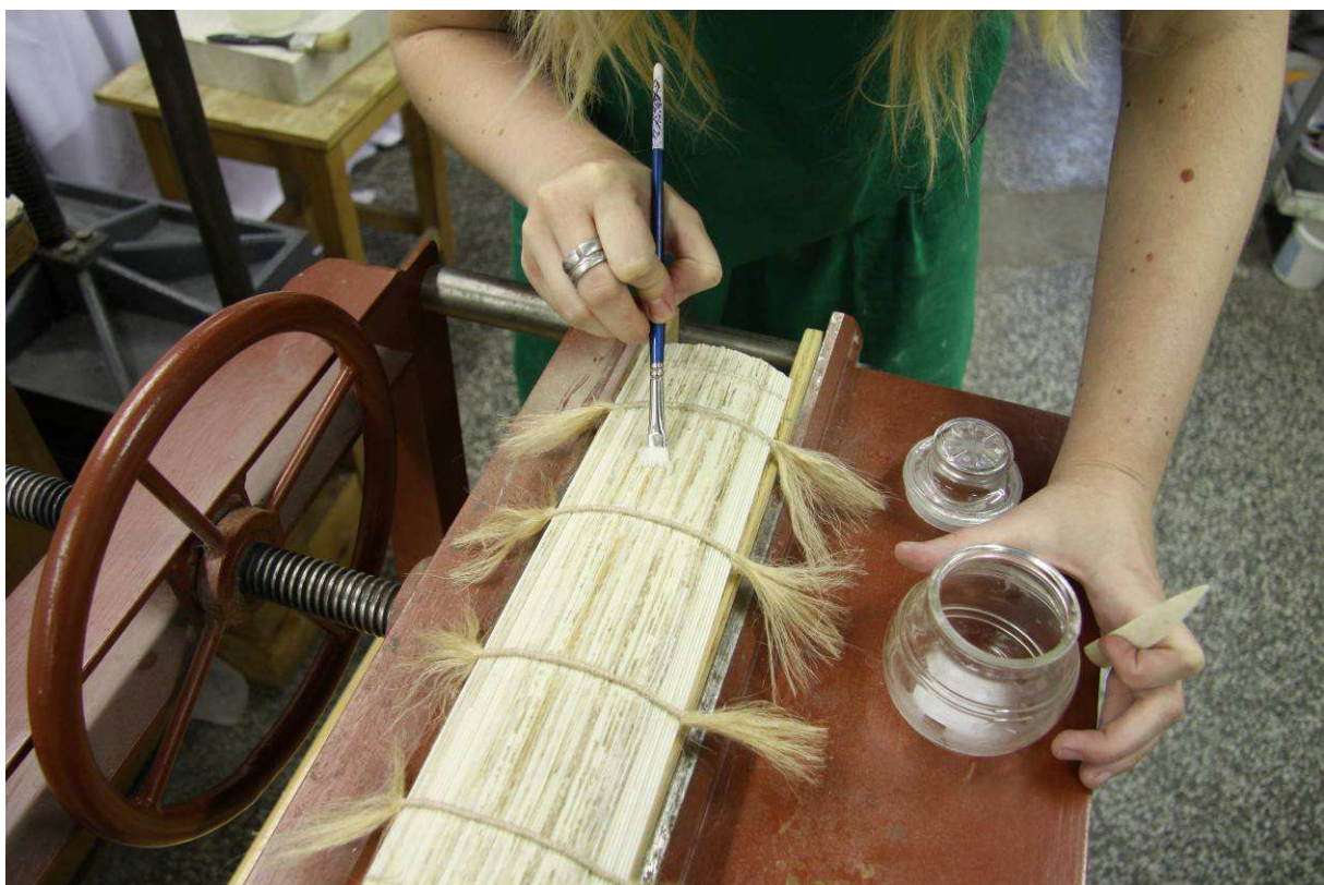
obr. č. 46 Klížení zkulaceného hřbetu
