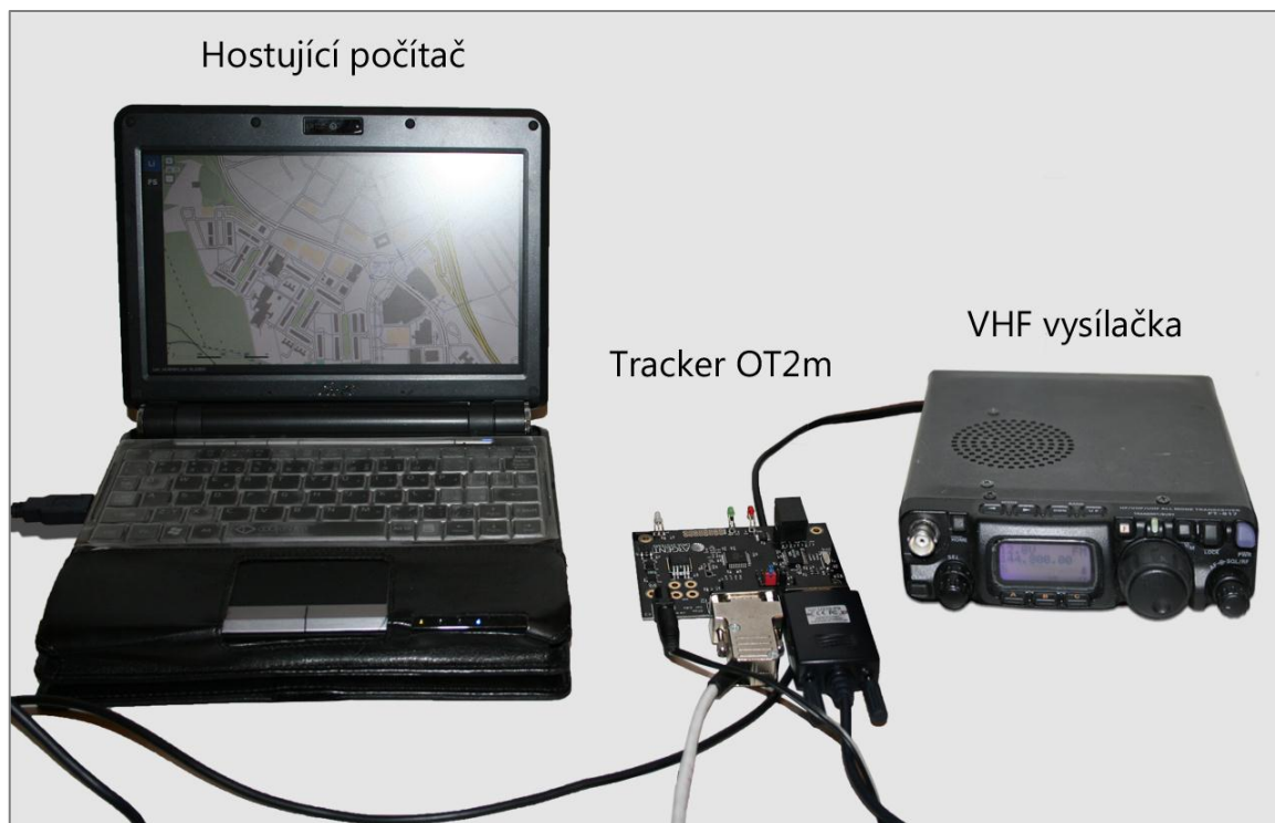
Obrázek 25: Testovací sestava – stacionární stanice
