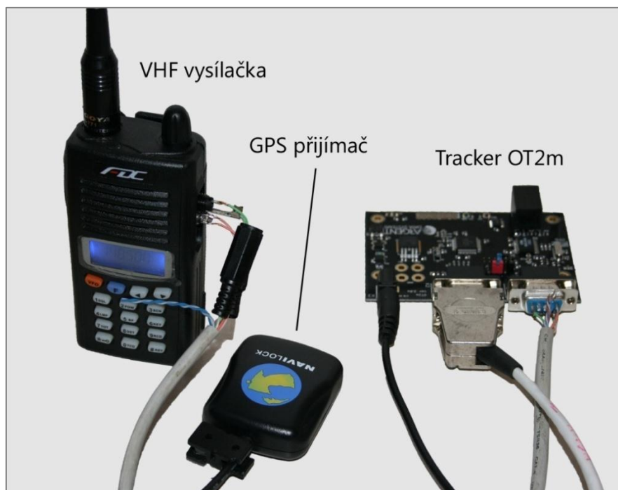
Obrázek 24: Testovací sestava – mobilní stanice
