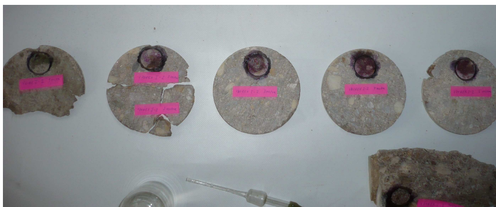
Obr.38 Fenolftaleinový test vzorků odřezaných z jádrového vývrtu
