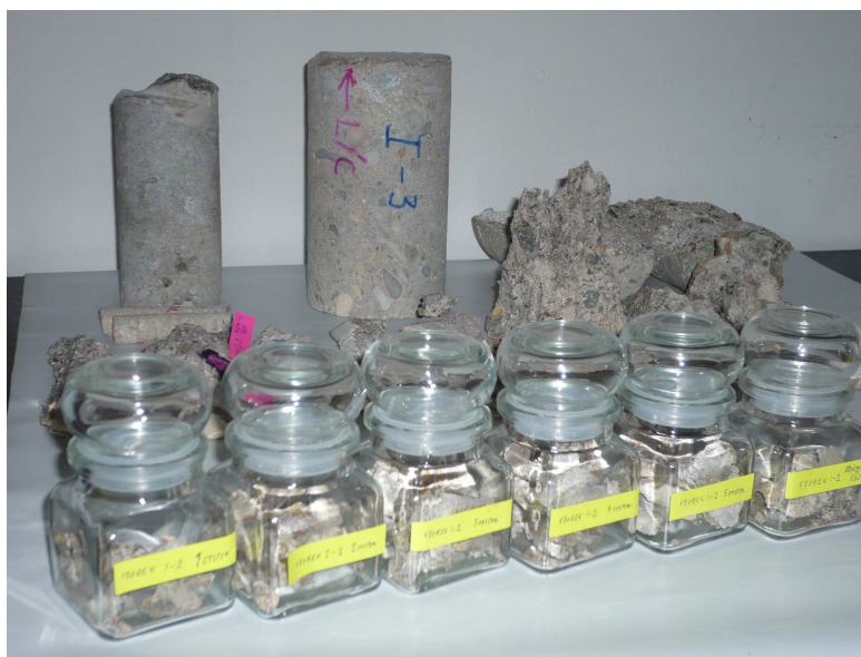
Obr.40 Výluh všech šesti vzorků
