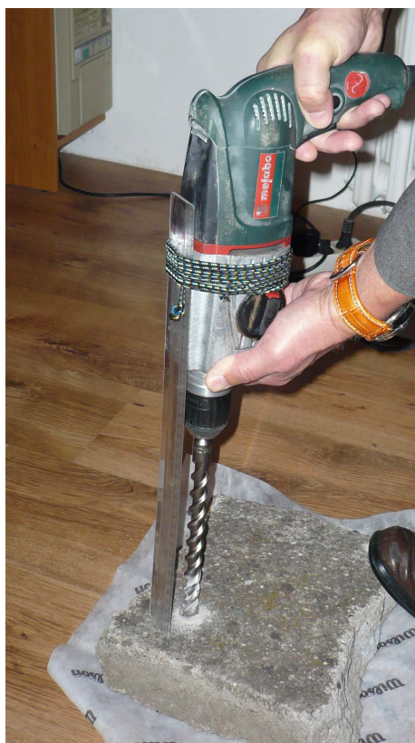
Obr.46 Vrtání zkušebního vývrtnu
