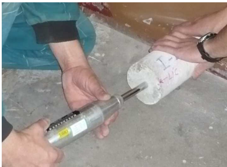
Obr.34 Měření Schmidtovým kladívkem N16
