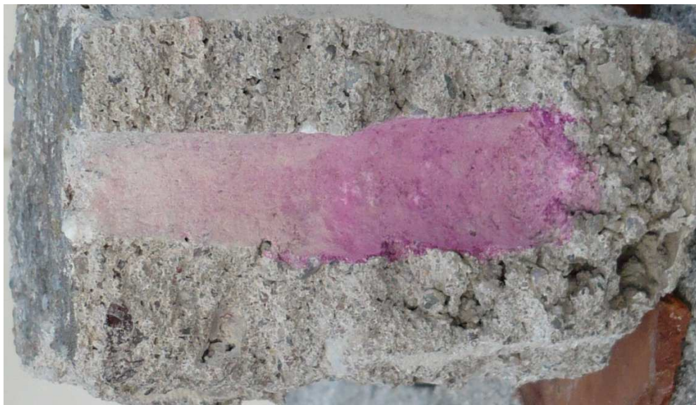
Obr.49 Fenolftaleinový test na rozlomeném vývrtnu
