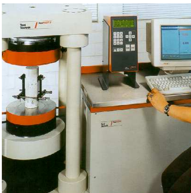
Obr.13 Hydraulický lis Toni PACT II na provádění tlakových zkoušek
