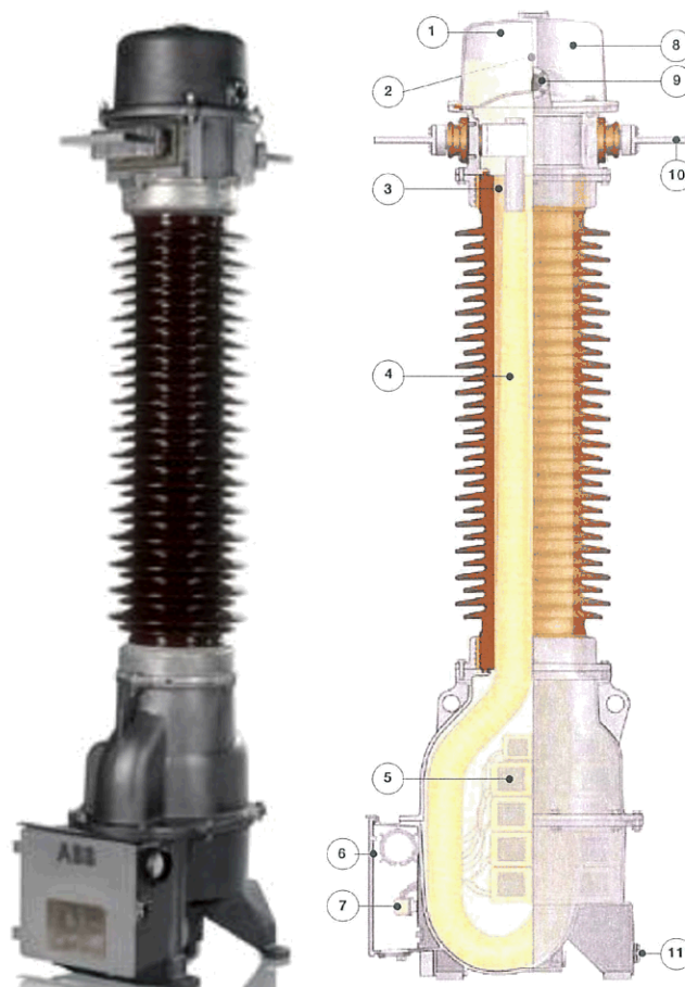
Obrázek 3.3a - Příklad tyčového přístrojového transformátoru proudu pro venkovní použití s uzavřeným feromagnetickým obvodem dole b) řez tímto tyčovým přístrojovým transformátorem proudu [6]
