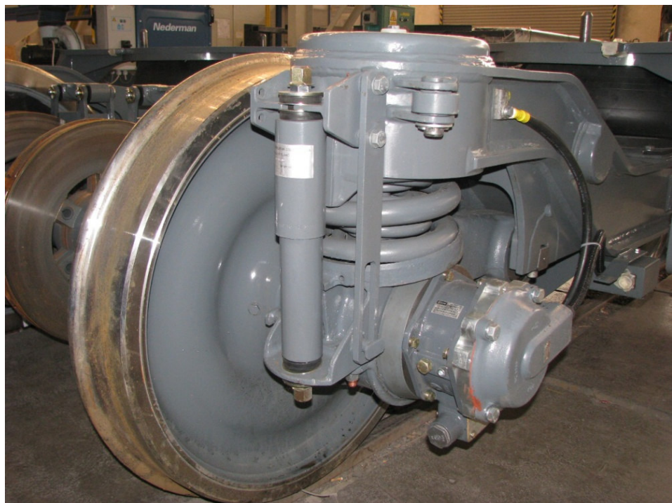
Obr. 29 Vedení dvojkolí kyvným ramenem běžného podvozku typu 8 – 834 elektrické jednotky řady 471 (Škoda Vagónka a.s.); [ 10]
