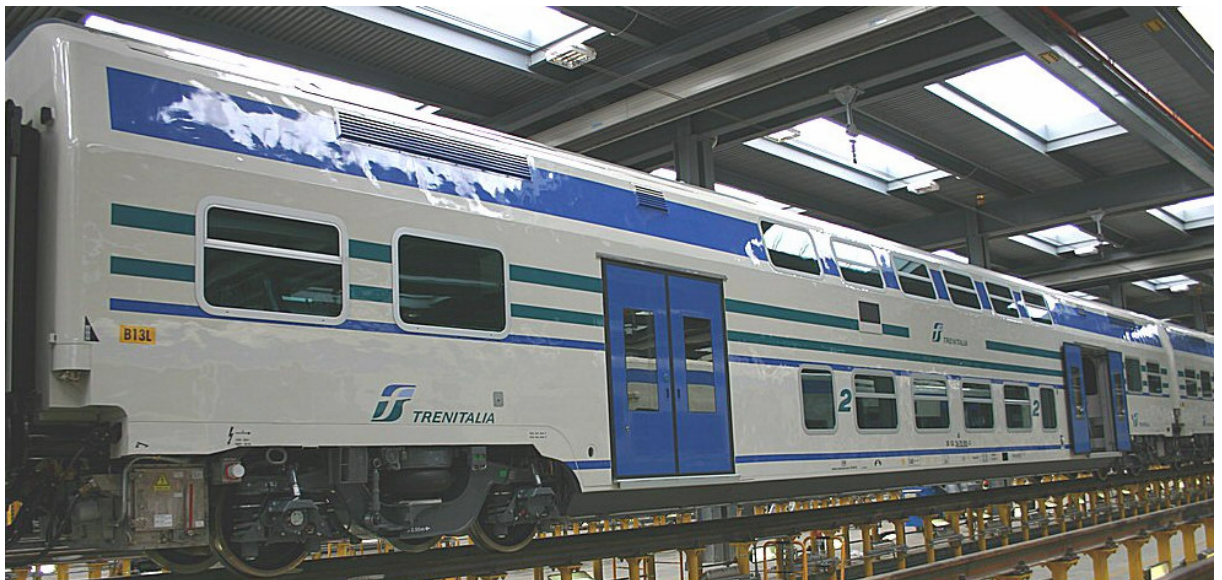
Obr. 75 Podvozek SF 400 na patrových vozech italské společnosti TRENITALIA [ 29]
