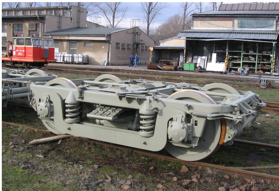
Obr. 3 Rozsochové vedení Pensylvánského podvozku elektrické jednotky řady 451/452 [ 35]
