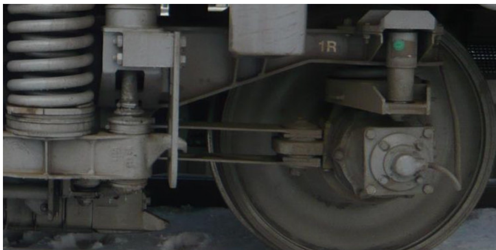
Obr. 27 Detail vedení zdvojeným pásem podvozku MD 523
