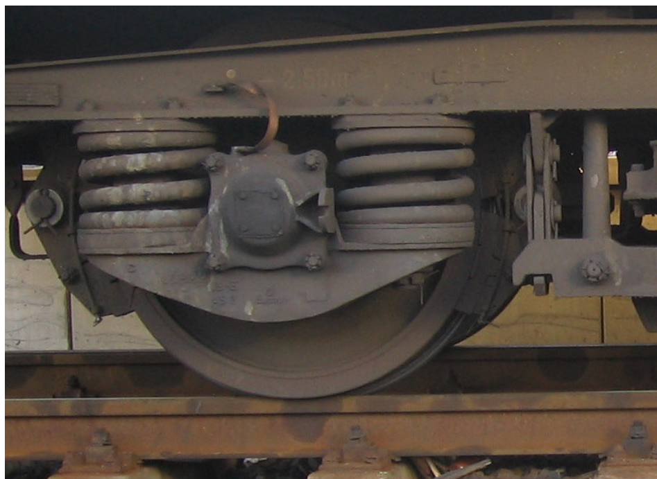
Obr. 8 Vedení svislými čepy podvozku Görlitz Va
