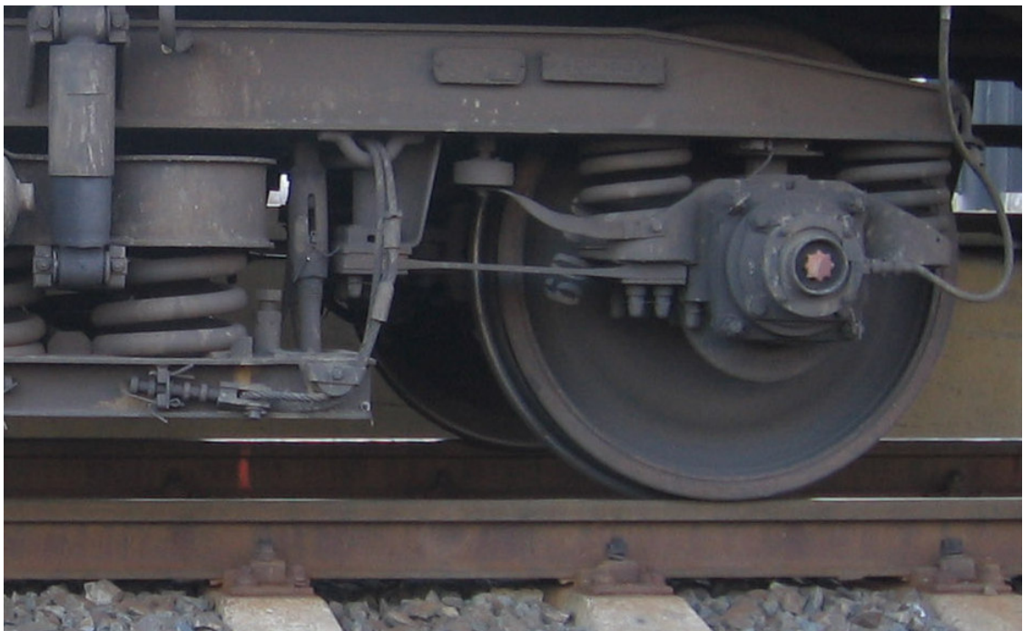
Obr. 24 Vedení dvojkolí a primární vypružení podvozku GP 200
