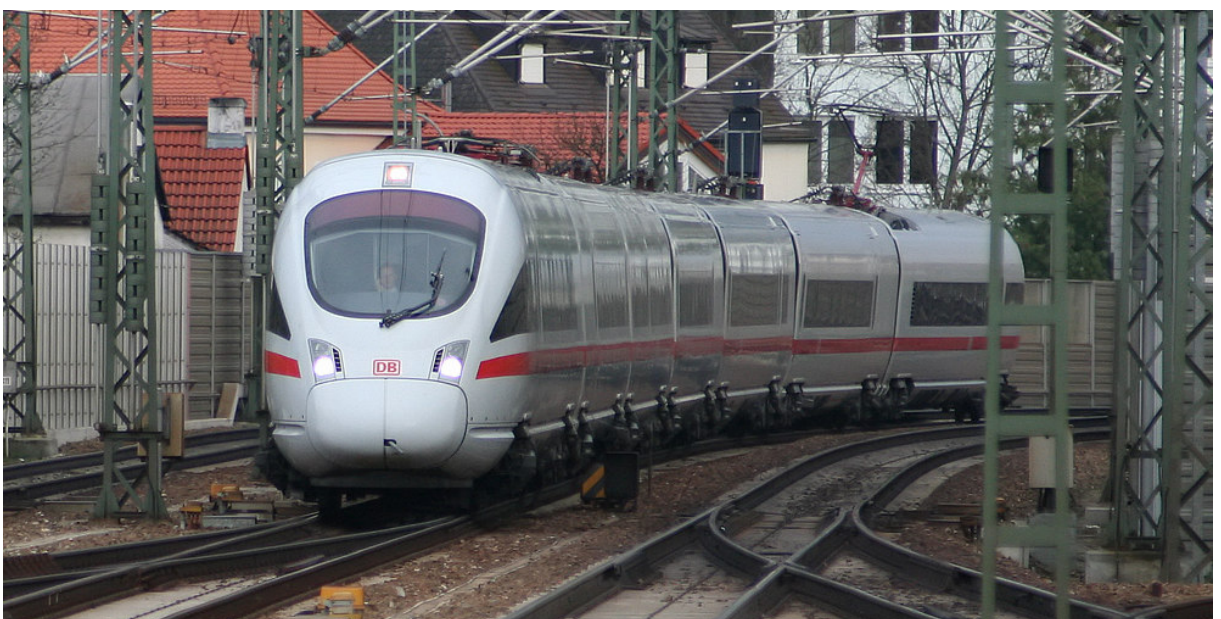
Obr. 104 Jednotka ICE – T se systémem nuceného naklápění skříní [ 34 ]
