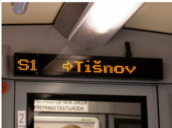
Obr. 5: LED panel uvnitř jednotky 814.2 Zdroj: Autor
