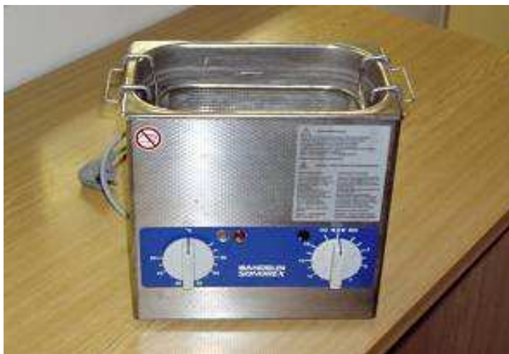
Obr. 59: Ultrazvuková lázeň BANDELIN SONOREX [26]
