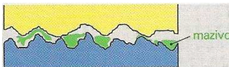
Obr. 3: Schéma vzniku smíšeného tření [11]
