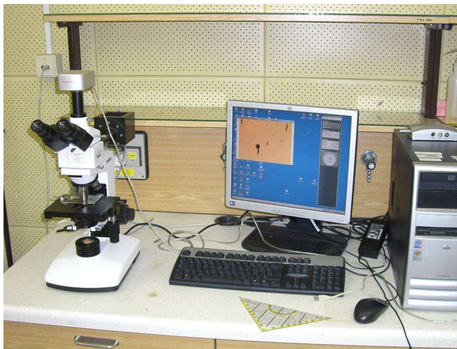
Obr. 30: Pracoviště pro ferrografickou analýzu [vlastní foto]
