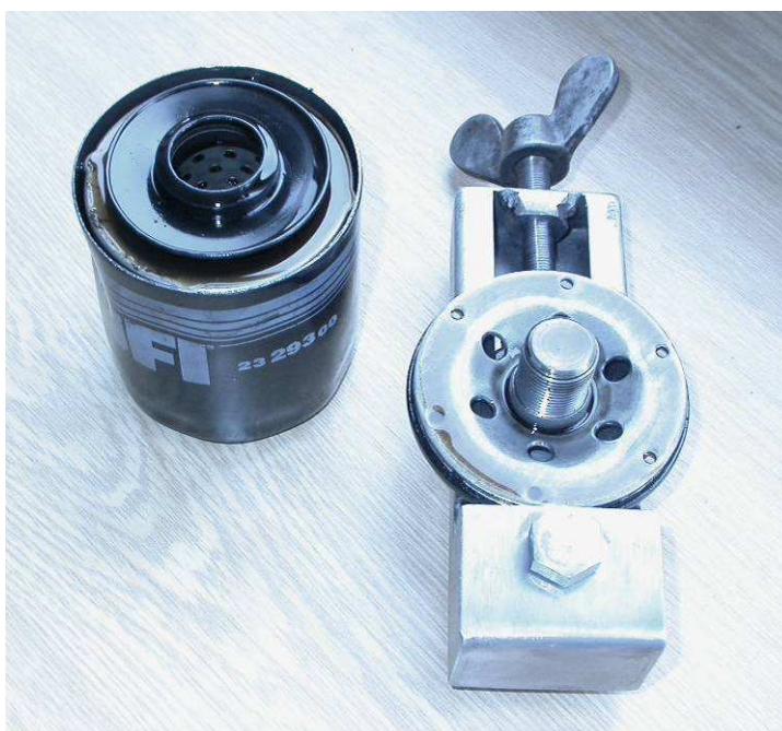
Obr. 60: Vyjmutí filtrační vložky za pomoci speciálního přípravku [25]
