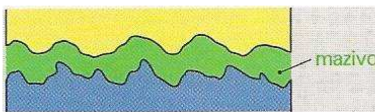
Obr. 2: Schéma vzniku kapalinného tření [11]
