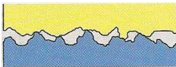
Obr. 1: Schéma vzniku suchého tření [11]
