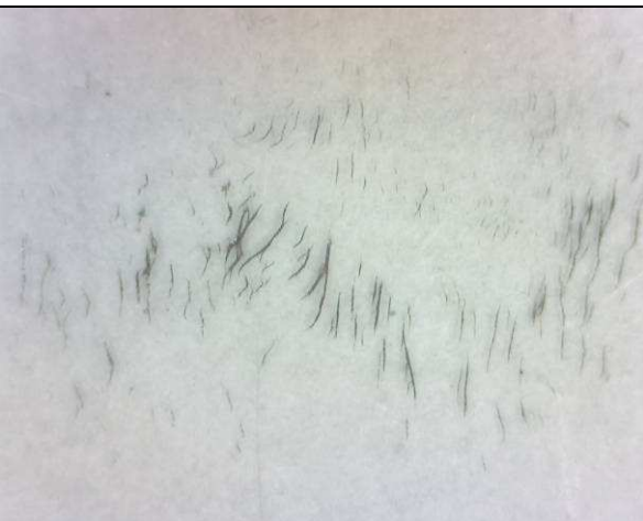
Obr. 126: Hodnocená plocha ze snímku ferrogramu – snímek z digitálního mikroskopu s USB připojením, zvětšení 230x
