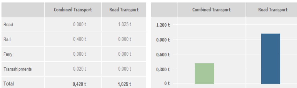
Obrázek č.15: Porovnání emisních ukazatelů Co2 mezi kombinovanou dopravou a silniční dopravou
