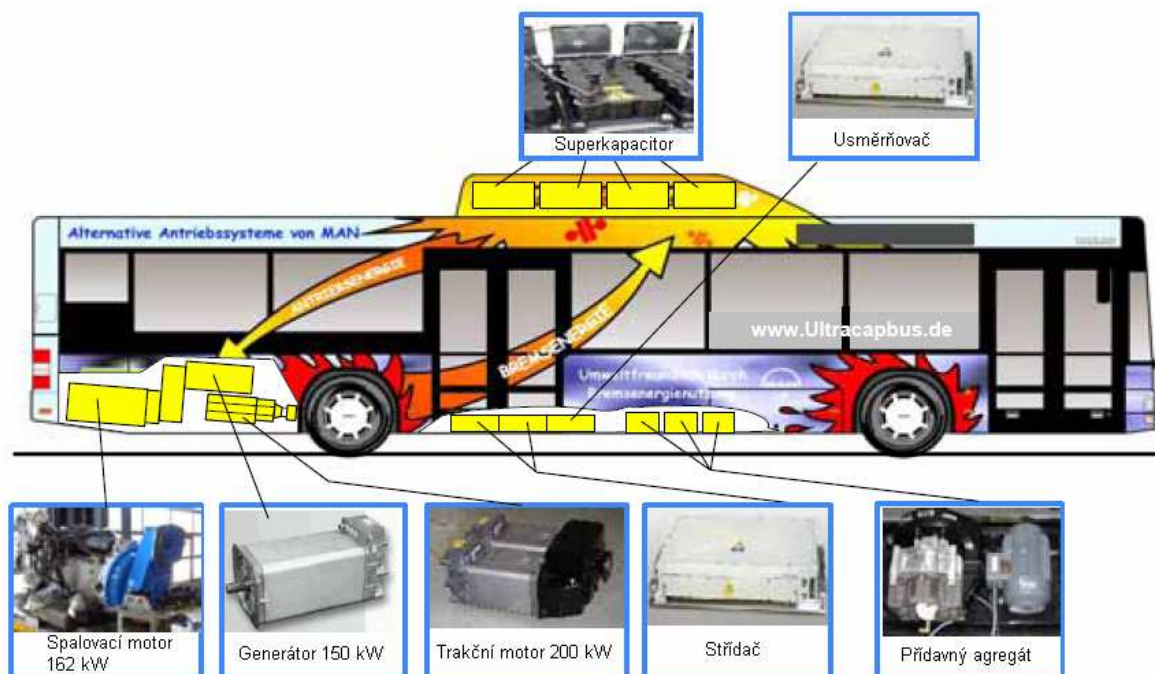
Obr. 8 Rozložení komponentů v hybridním autobuse [8]
