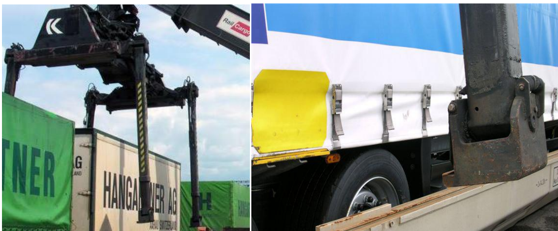
Obrázek 13: Kleštiny a uchycení sedlového návěsu
