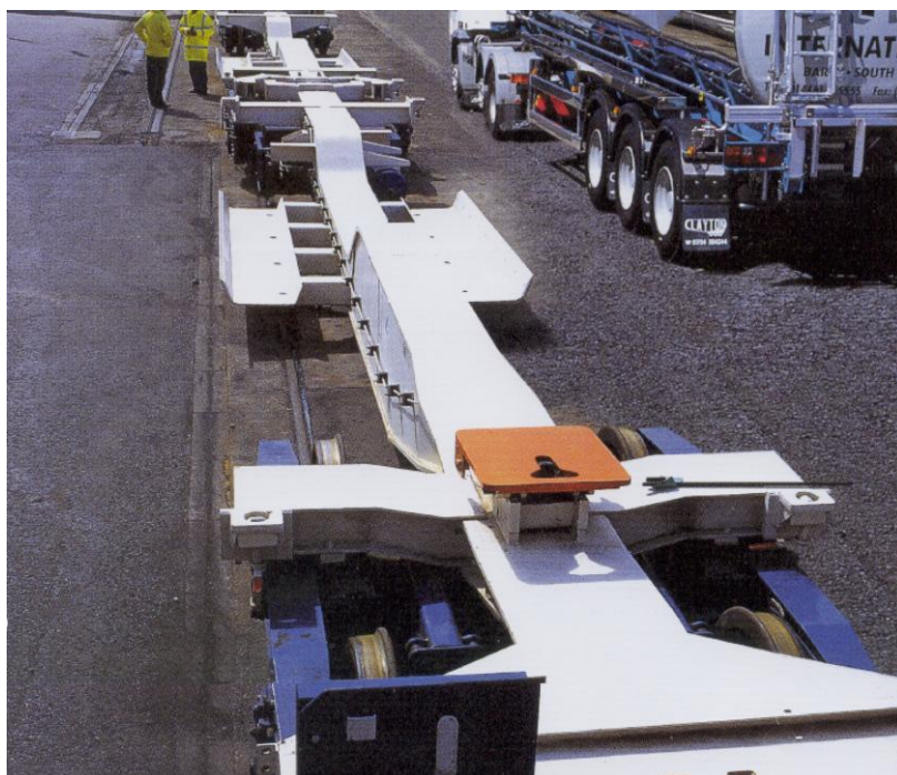
Obrázek 11: Železniční vůz EuroSpine
