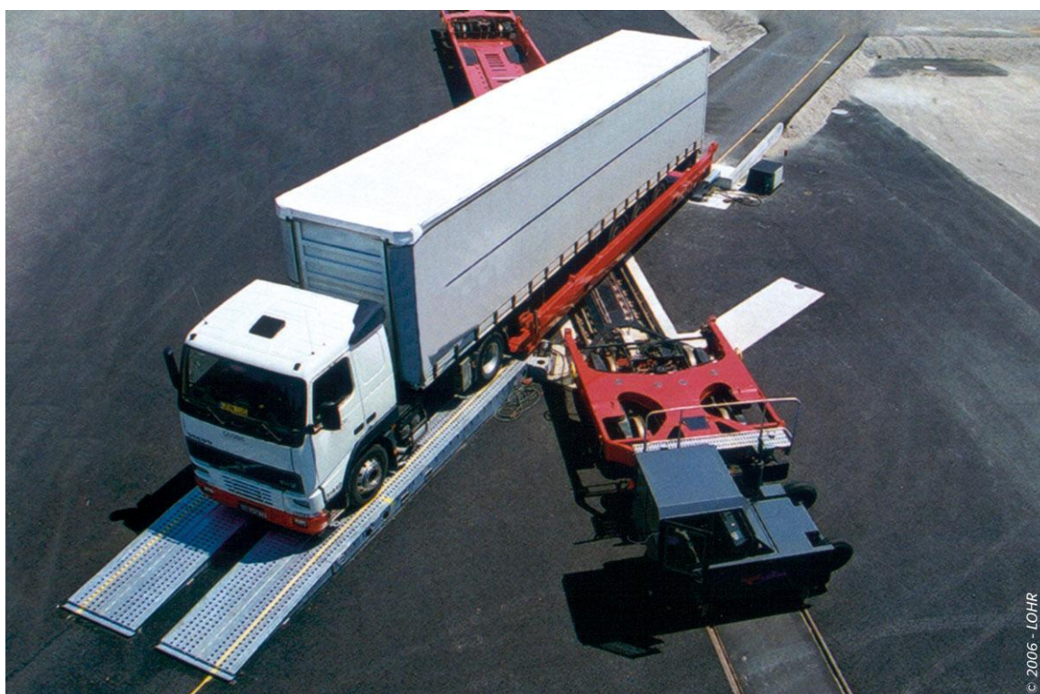
Obrázek 8: Nakládka vozu modalohr
