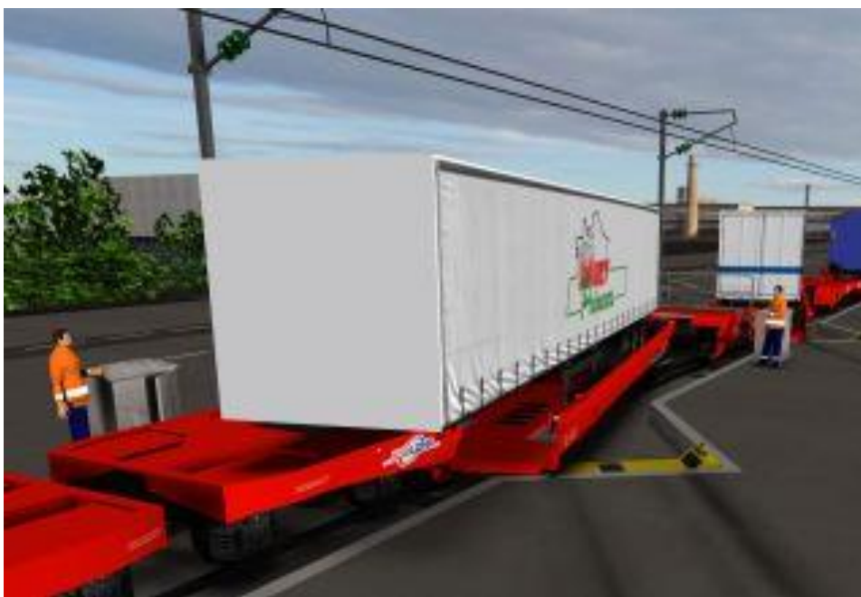
Obrázek 15: Překládka návěsu systémem Modalohr
