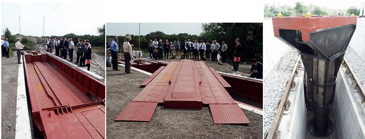
Obrázek 17: Vůz, otočná podlaha a zařízení pro otáčení systému CargoSpeed
