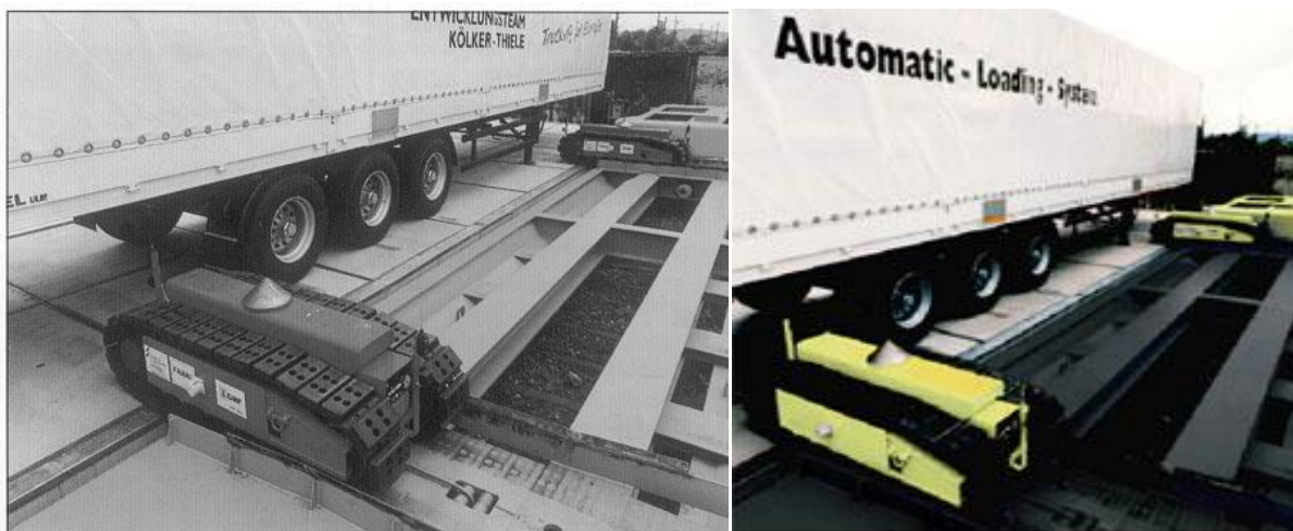
Obrázek 19: Systém překládky CargoRoo
