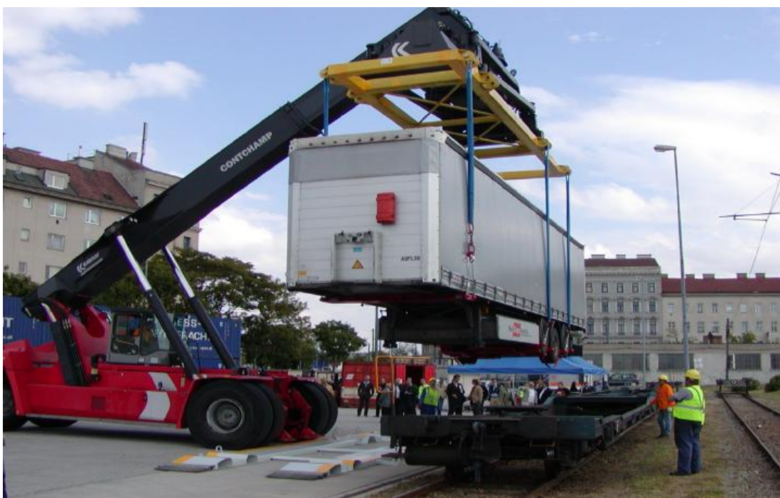
Obrázek 23: Překládka na kapsový vůz
