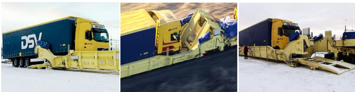
Obrázek 18: Přeprava vozem Flexiwaggon; nakládka – doprava – vykládka
