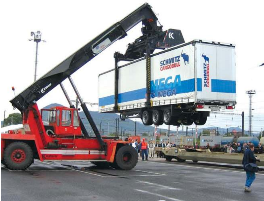
Obrázek 12: Výsuvný stohovač s kleštinami při překládce sedlového návěsu
