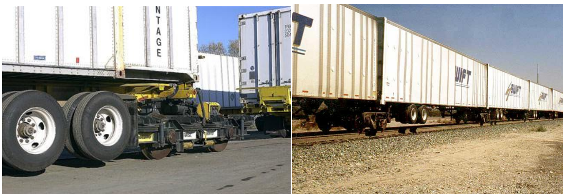
Obrázek 14: Železniční podvozek systému; Ucelený vlak bimodálních návěsů
