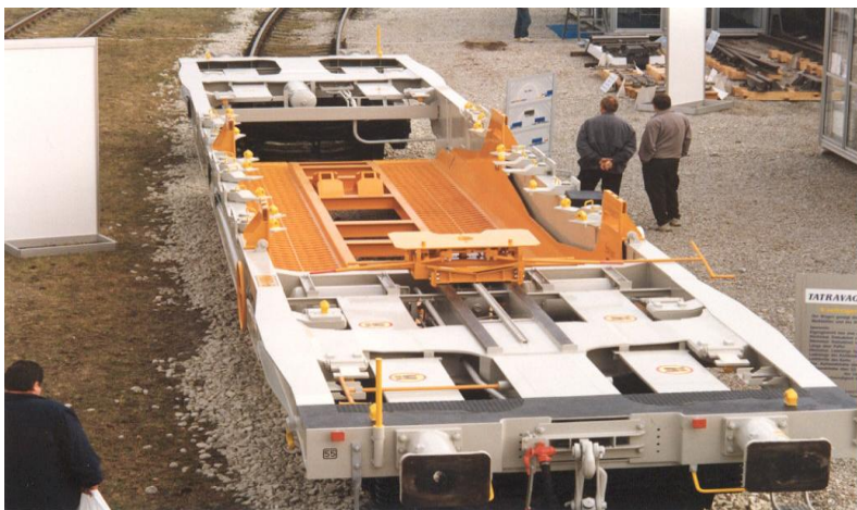
Obrázek 7: Košový železniční vůz řady Sdgmss
