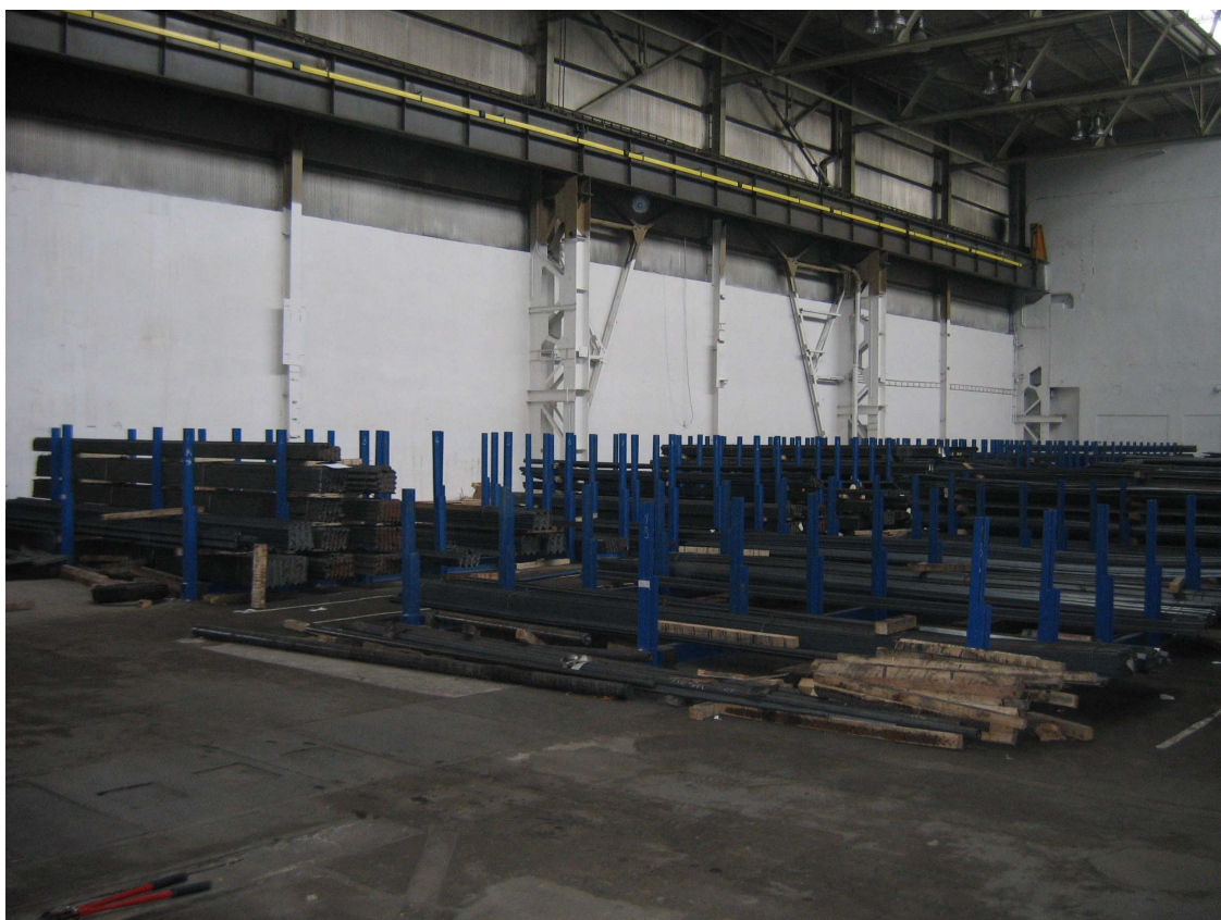
Obrázek 4: Hřebenové regály pro skladování tyčového materiálu
