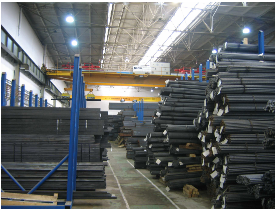
Obrázek 3: Hřebenový regál pro skladování betonářské oceli
