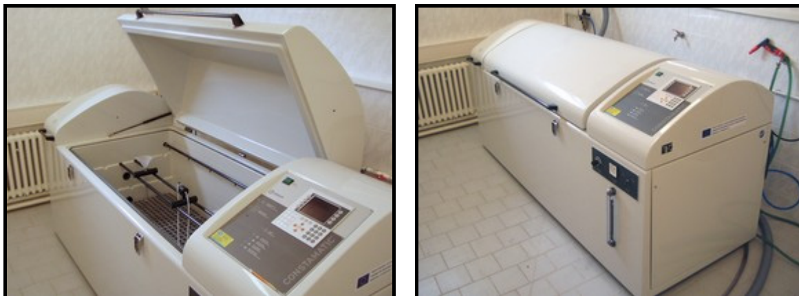
Obr. 4.5 Korozní komora Liebis SKBW-1000 A-TR [18]
