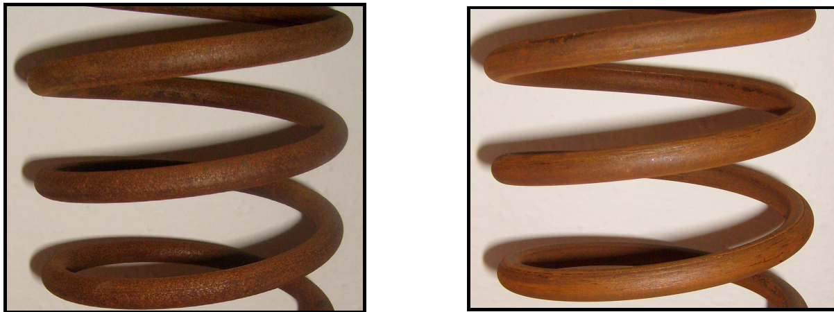
Obr. 4.8 Výsledný stav korozi zasažené pružiny
