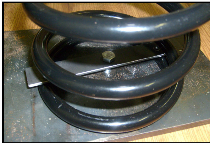
Obr. 6.11 Ukotvení automobilové pružiny během experimentu
