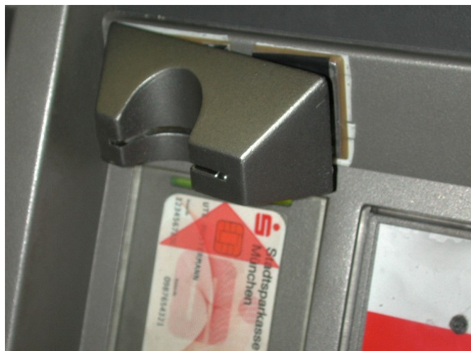
Obrázek 11 - detailní pohled na skimmovací zařízení, (zdroj: vlastní)
