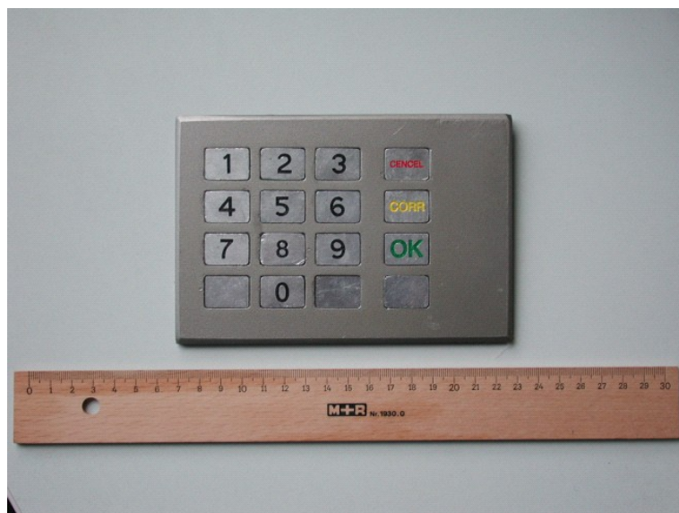
Obrázek 9 - vyjmutá falešná klávesnice, (zdroj: vlastní)
