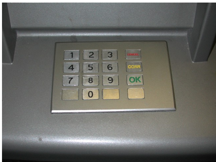
Obrázek 8 - falešná klávesnice na bankomatu, (zdroj: vlastní)
