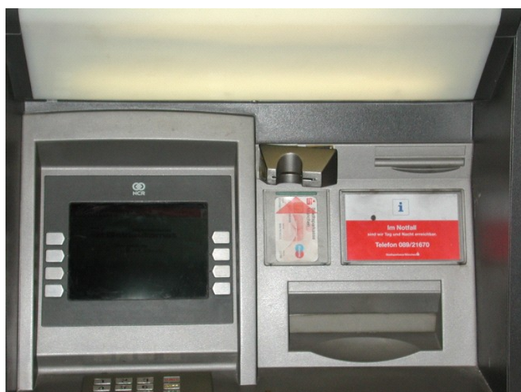
Obrázek 10 - skimmovací zařízení připevněné na bankomatu, (zdroj: vlastní)
