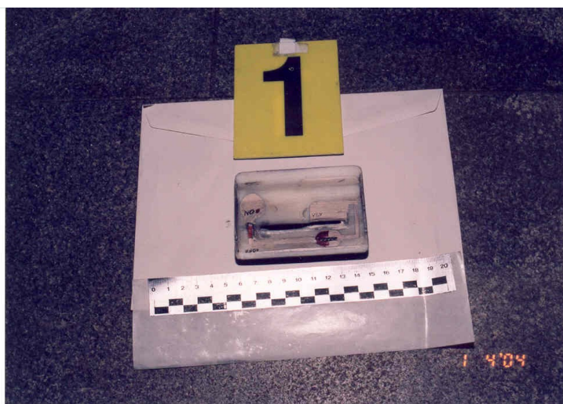
Obrázek 22 - pohled na vnitřek skimmovacího zařízení, (zdroj: vlastní)
