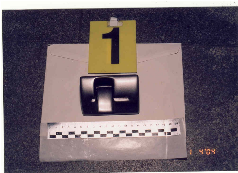
Obrázek 21 - pohled na skimmovací zařízení, (zdroj: vlastní)
