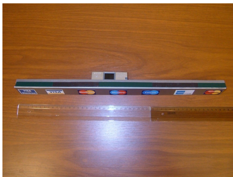
Obrázek 14 - pohled na horní lištu s digitálním fotoaparátem, (zdroj: vlastní)
