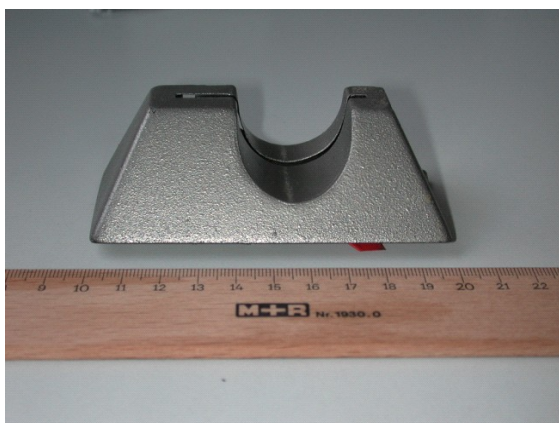
Obrázek 12 - vyjmuté skimmovací zařízení, (zdroj: vlastní)
