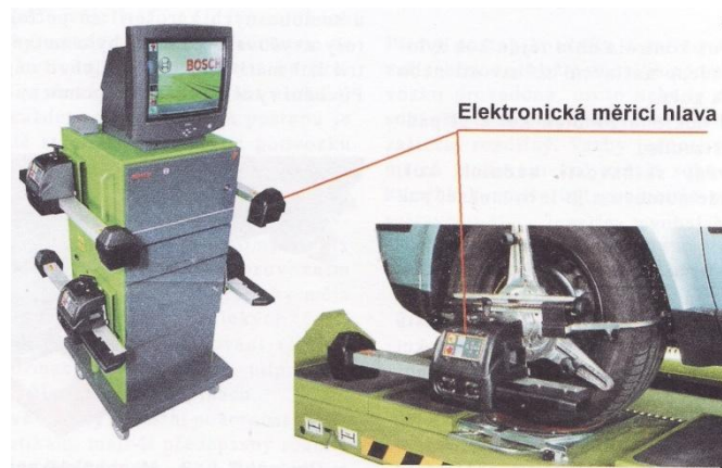
Obrázek 24: Elektronický přístroj pro měření geometrie kol
