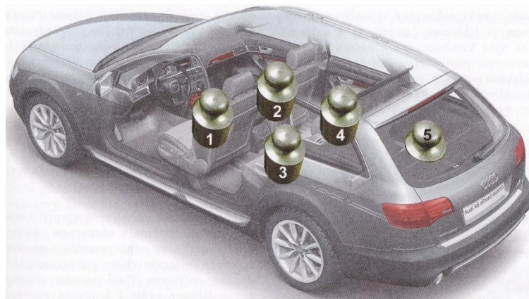
Obrázek 18: Varianty zatížení vozidla při kontrole geometrie
