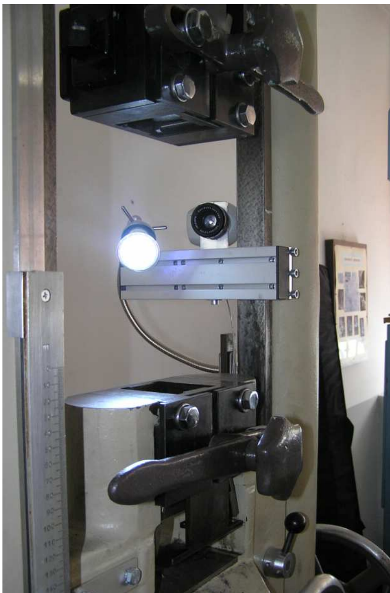
OBR. 20 Uchycení kamery a lampy na zkušebním zařízení
