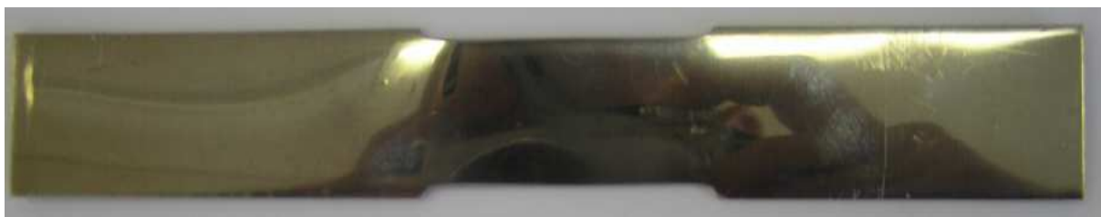
OBR. 30 Vhodný nepoměrný tvar zkušebního tělíska, tvz. tvar kosti
