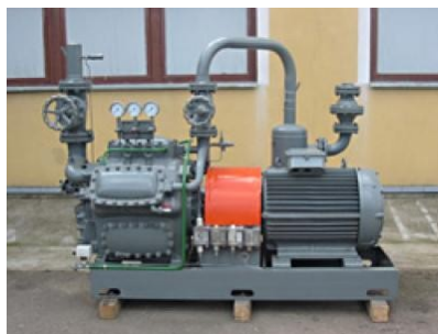
Obrázek 2 – Pístový kompresor Nf611 [2]
