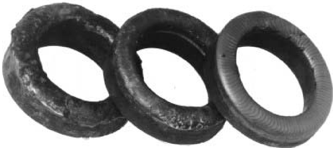
Obr. 5 – Porovnání návarů: ručně obalovanou elektrodou, drátem pod tavidlem, plazmatem [9]
