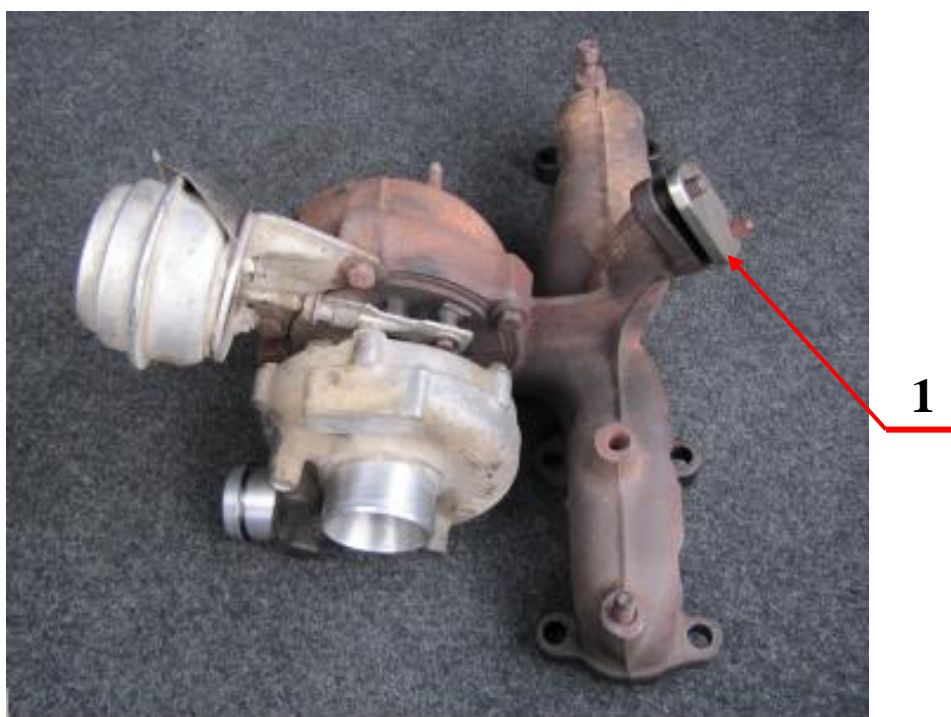
Obr. 25: Zaslepení zpětného vedení výfukových spalin
