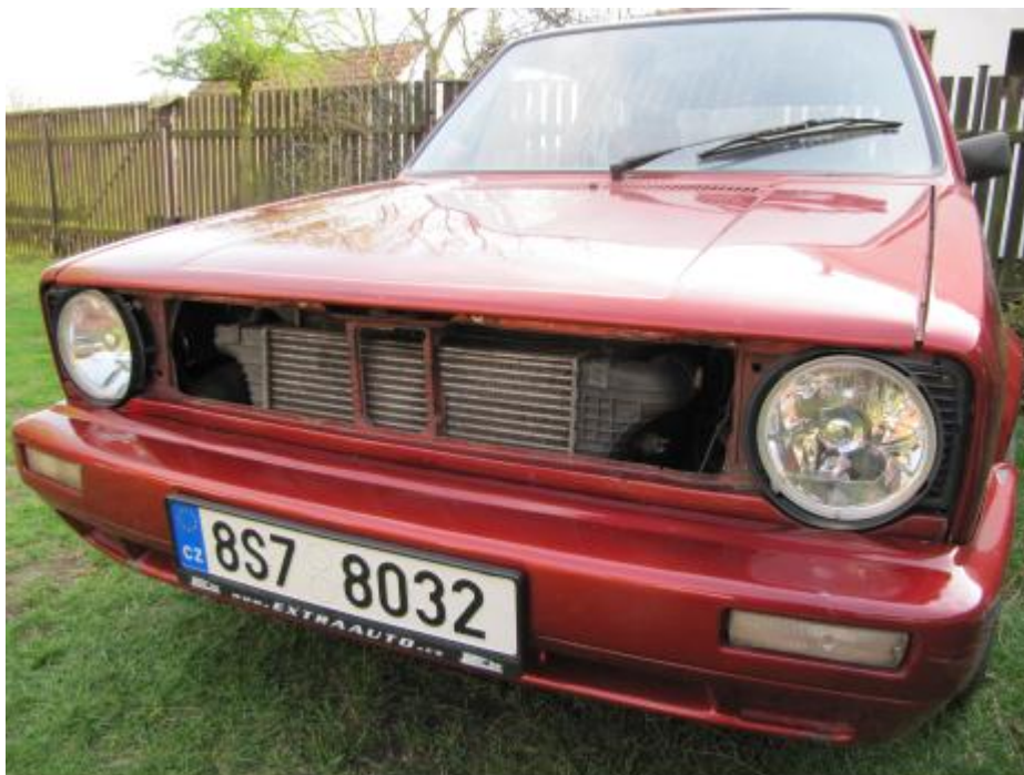
Obr. 22: Umístění mezichladiče plnicího vzduchu (intercooler)
