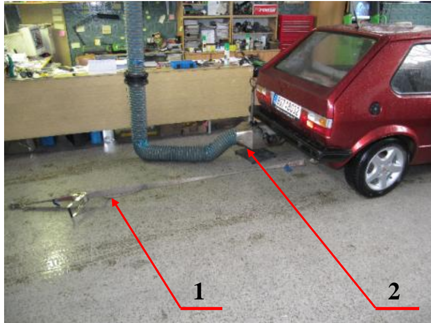
Obr. 29: Odsávací zařízení a zajištění vozidla
