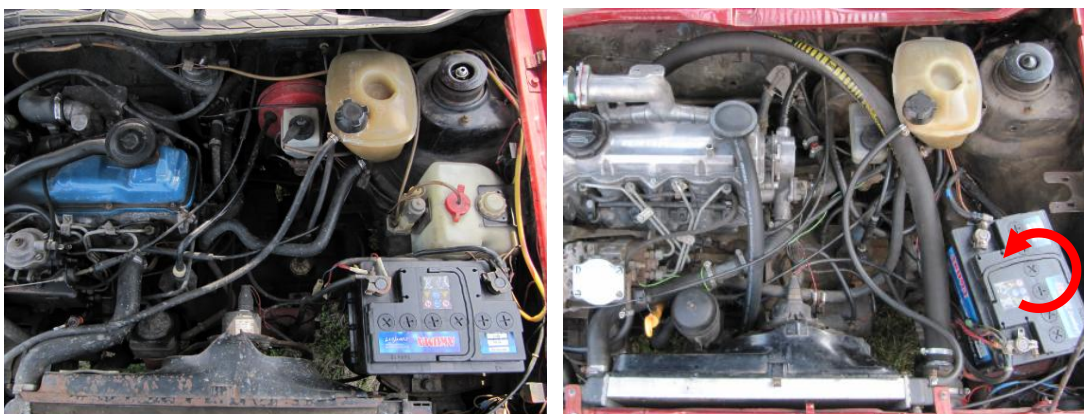
Obr. 26: Změna polohy akumulátoru
