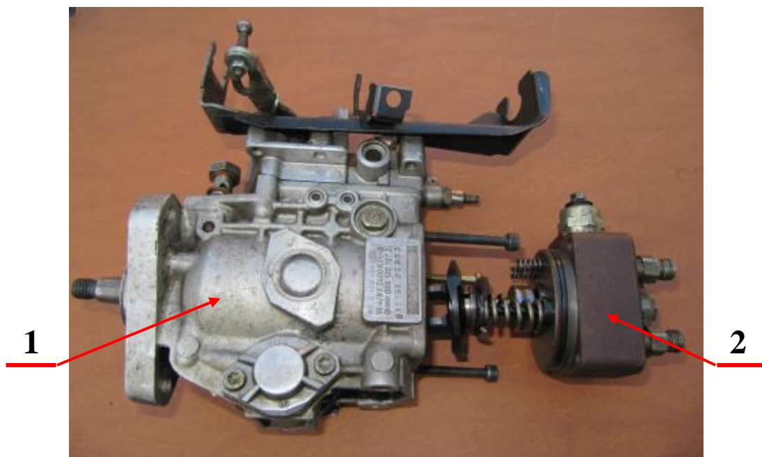
Obr. 17: Úprava vstřikovacího čerpadla
