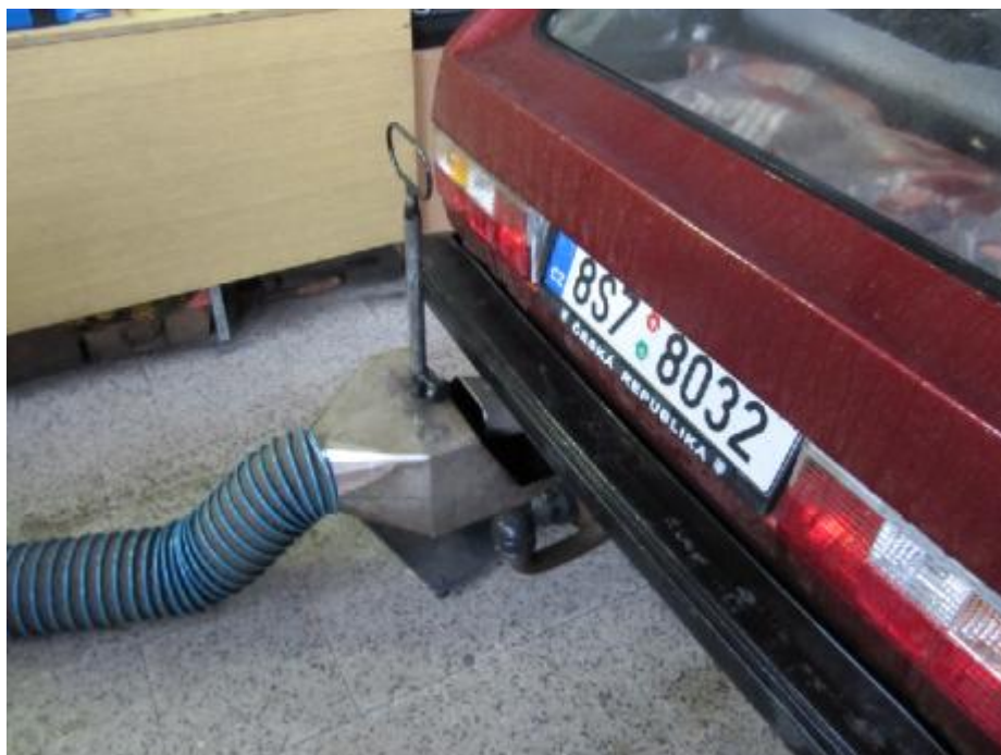
Příloha č. 8: Připojení odsávacího zařízení výfukových plynů
