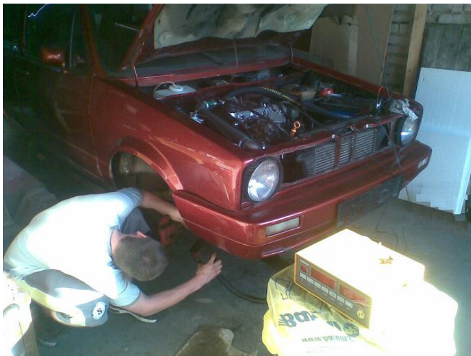
Příloha č. 2: Měření dynamického předvstřiku
