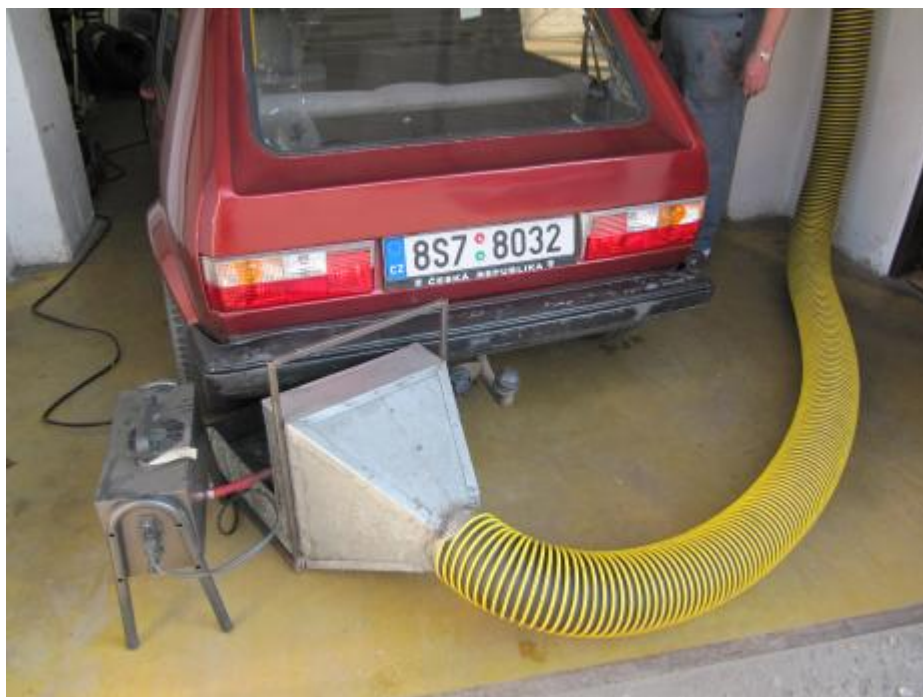
Příloha č. 16: Připojení odsávání výfukových spalin
