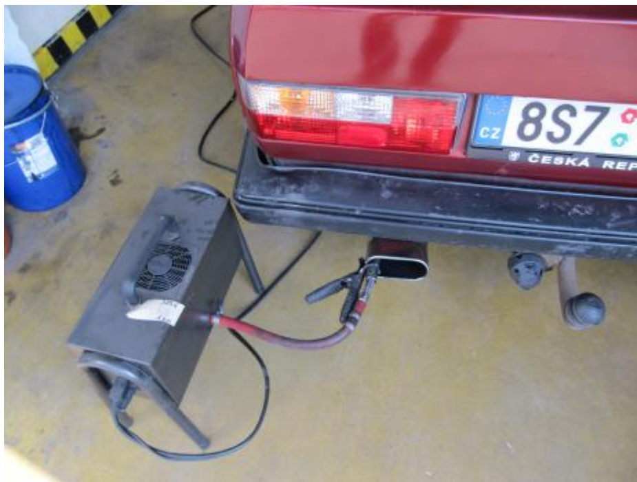
Příloha č. 16: Připojení odsávání výfukových spalin
