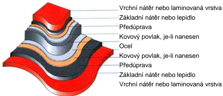
Obrázek č.3: Vrstvy nátěrových hmot ocelového dílu karosérie [1]
