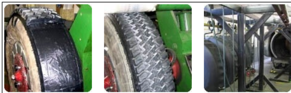
Obr. 6. – Protektorování "za studena" [6]
