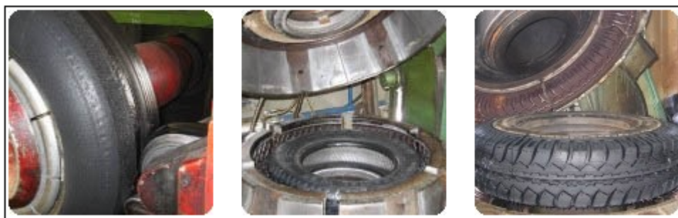
Obr. 7. – Protektorování "za tepla" [6]
