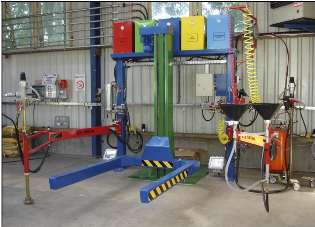
Obr. 3. – Stanice na odčerpávání provozních náplní [15]
