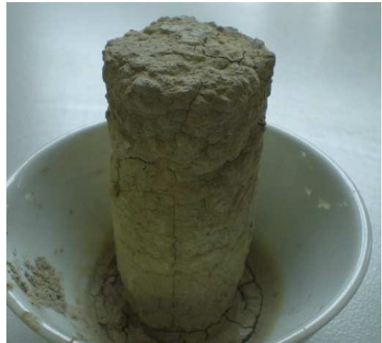
Obrázek 6-14: Vzorky po 7 dnech – zemina bez zlepšení 1. – děšť, 2. – HPV [0]
