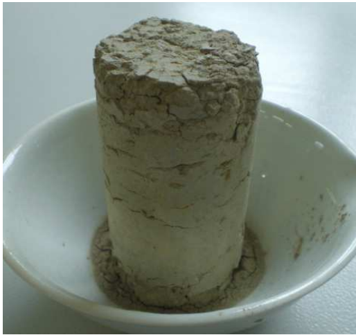
Obrázek 6-14: Vzorky po 7 dnech – zemina bez zlepšení 1. – děšť, 2. – HPV [0]
