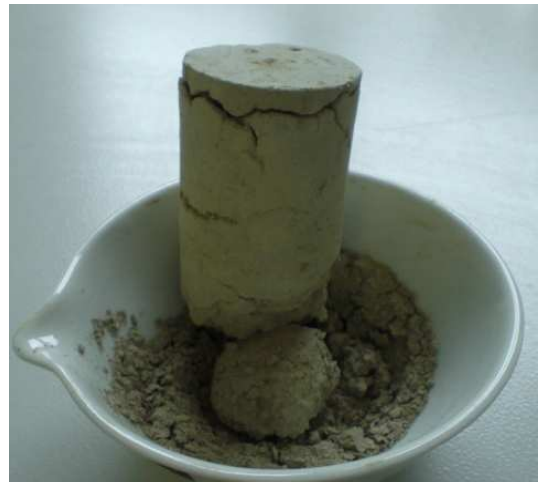
Obrázek 6-14: Vzorky po 7 dnech – zemina bez zlepšení 1. – děšť, 2. – HPV [0]
