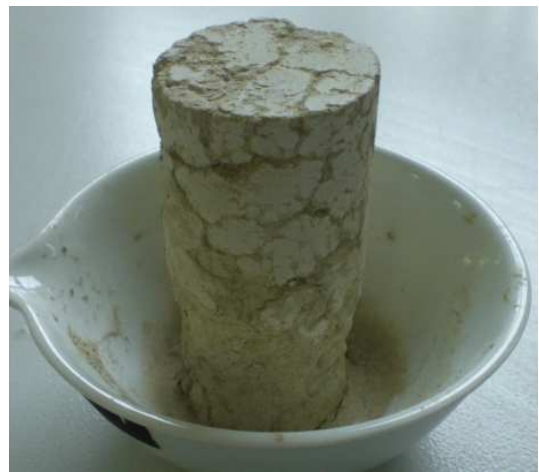
Obrázek 6-16: Vzorky po 7 dnech – zemina + 3 % port. cementu 1. – děšť, 2. – HPV [0]
