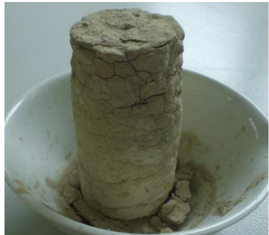
Obrázek 6-17: Vzorky po 7 dnech – zemina + 5 % váp. hydrátu 1. – děšť, 2. – HPV [0]
