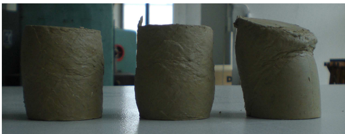
Obrázek 6-8: Ukázka porušení zeminy – zemina + 3 % vápenného hydrátu [0]
