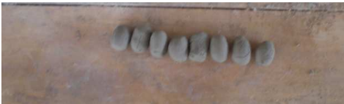
Obrázek 5-8: Příprava válečků o průměru cca 6 mm [0]
