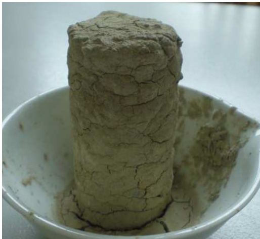
Obrázek 6-17: Vzorky po 7 dnech – zemina + 5 % váp. hydrátu 1. – děšť, 2. – HPV [0]
