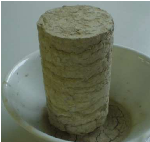
Obrázek 6-14: Vzorky po 7 dnech – zemina bez zlepšení 1. – děšť, 2. – HPV [0]
