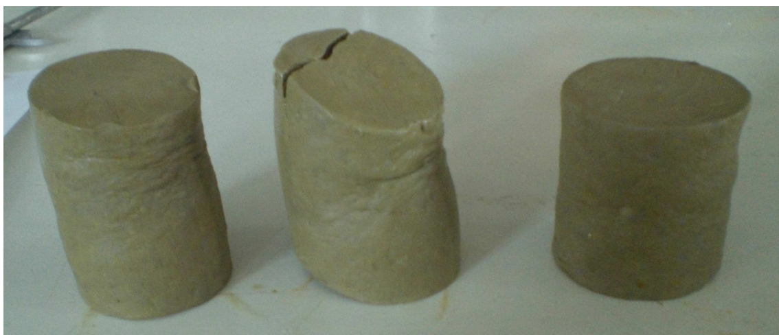
Obrázek 6-7: Ukázka porušení zeminy – zemina bez zlepšení [0]
