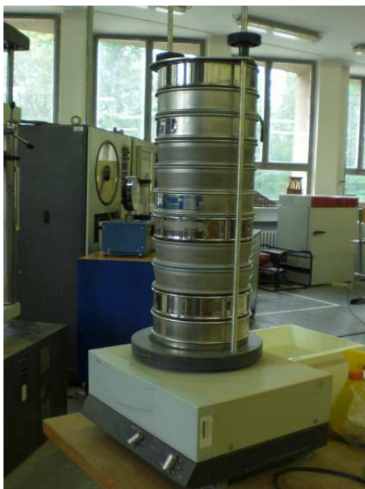
Obrázek 5-10: Sada sít a výsledky sítového rozboru [0]
