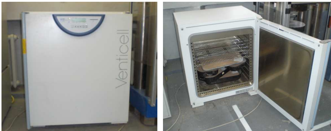
Obrázek 5-2: Sušárna s nucenou recyklací vzduchu VENTICELL 111 [0]
