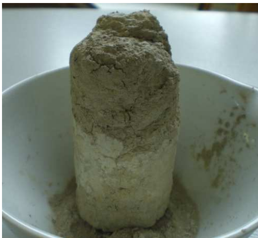
Obrázek 6-16: Vzorky po 7 dnech – zemina + 3 % port. cementu 1. – děšť, 2. – HPV [0]
