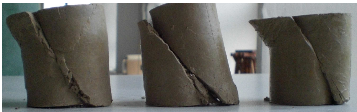
Obrázek 6-11: Ukázka porušení zeminy – zemina + 5 % portlandského cementu C32,5 [0]
