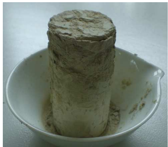
Obrázek 6-18: Vzorky po 7 dnech – zemina + 5 % port. cementu 1. – děšť, 2. – HPV [0]
