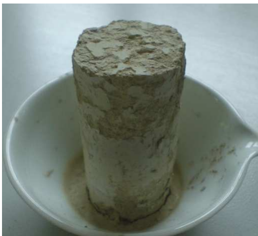
Obrázek 6-18: Vzorky po 7 dnech – zemina + 5 % port. cementu 1. – děšť, 2. – HPV [0]
