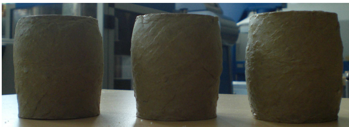
Obrázek 6-10: Ukázka porušení zeminy – zemina + 5 % vápenného hydrátu [0]
