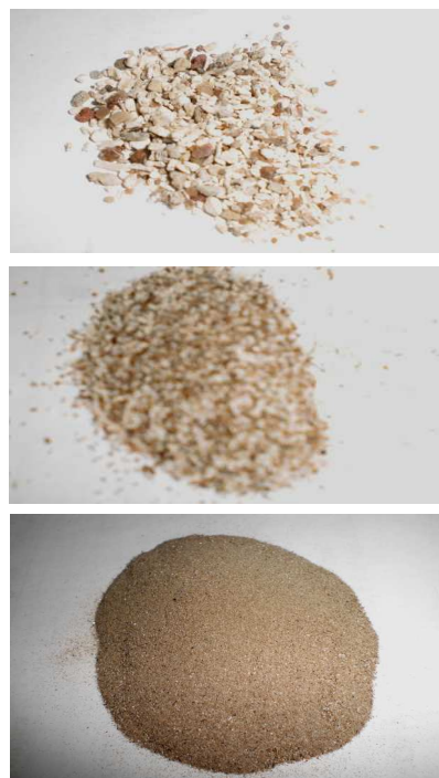
Obrázek 5-10: Sada sít a výsledky sítového rozboru [0]
