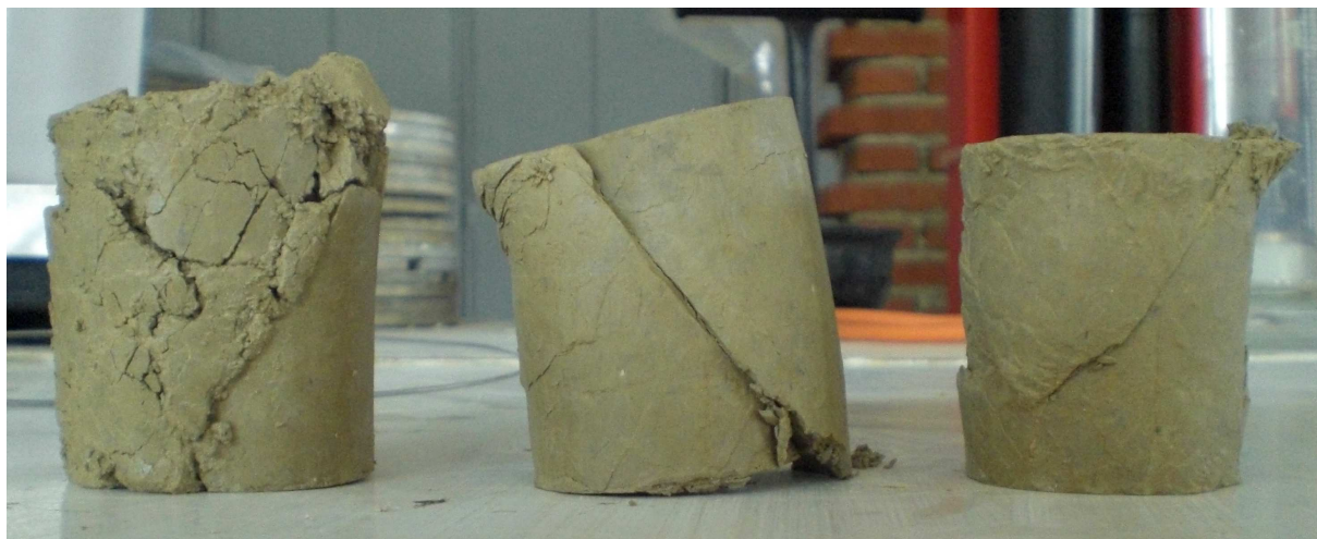
Obrázek 6-9: Ukázka porušení zeminy – zemina + 3 % portlandského cementu C32,5 [0]
