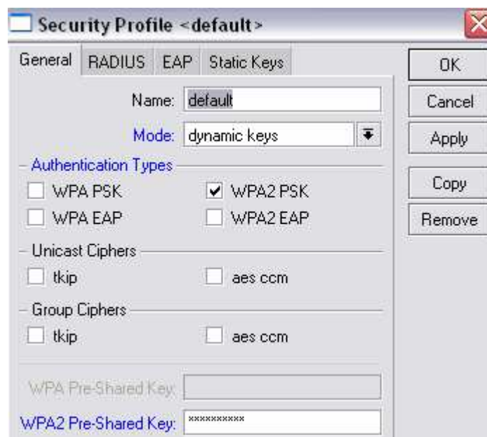
Obr. 25 Nastavení profilu pro zabezpečení přenosu
