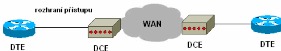
Obr. 6 Rozhraní přístupu, zařízení DTE, DCE 6
