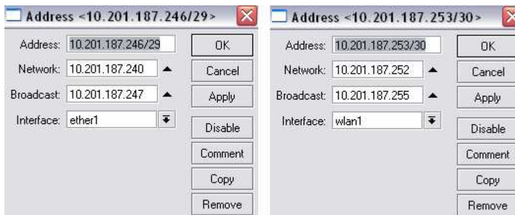
Obr. 19 Nastavování IP adres pro rozhraní ether1 a wlan1
