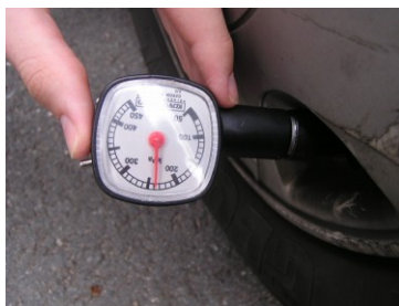
Obr.52. Měření tlaku huštění pneumatiky tlakoměrem
