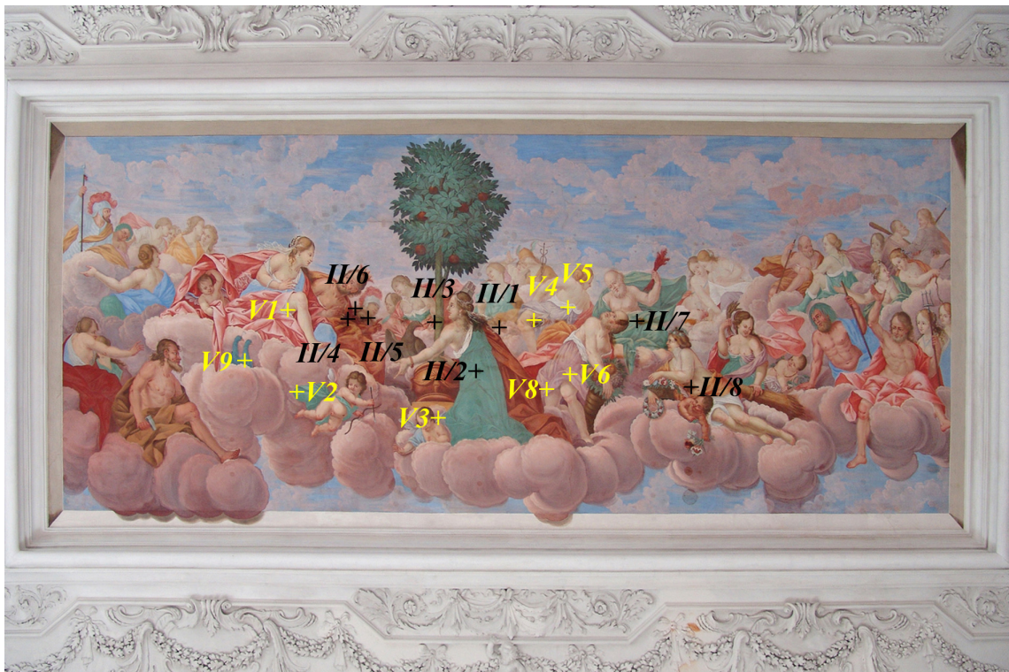
4. Vyznačení míst odběru vzorků. Žlutě jsou vyznačeny vzorky barevných vrstev, černě vzorky pro identifikaci hnědého zbarvení.
