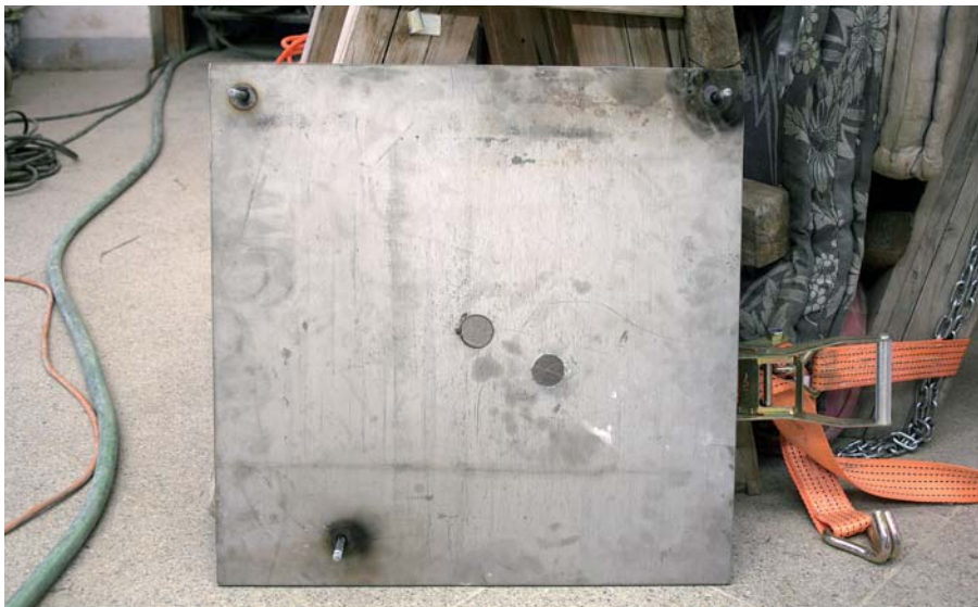
Obr. 27) Nerezová deska s otvory pro nový i starý čep (pro případ zpětného osazení do exteriéru) a se třemi malými záchytnými čepy.
