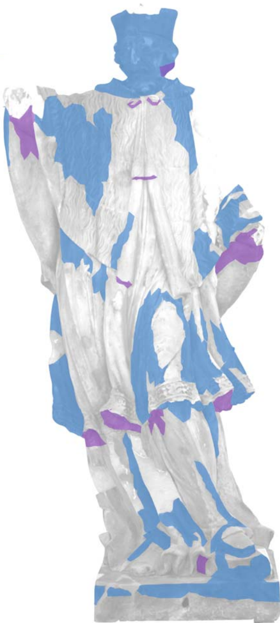
9) Zákres výskytu sádrovcových krust a silikátových nečistot na soše světce. Čelní pohled.
