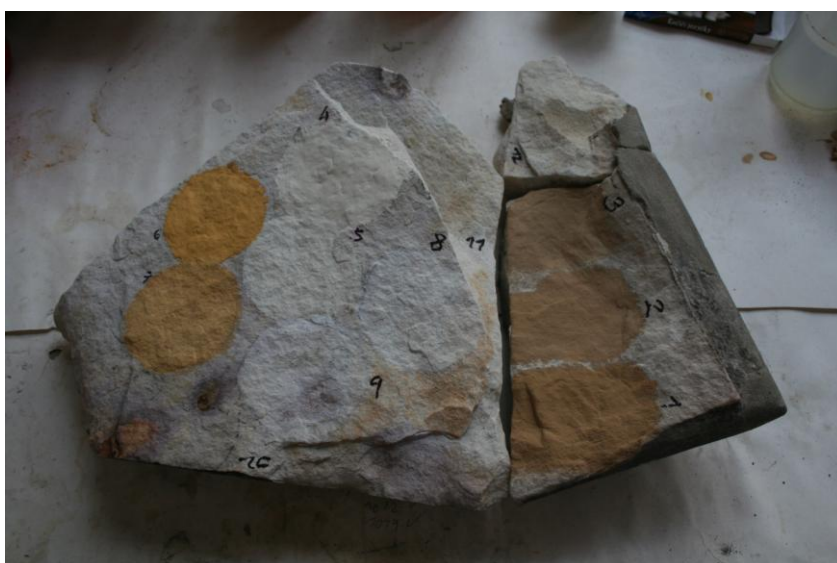
Obr. 5) Zkoušky nasákavosti povrchu ošetřeného různými přípravky
