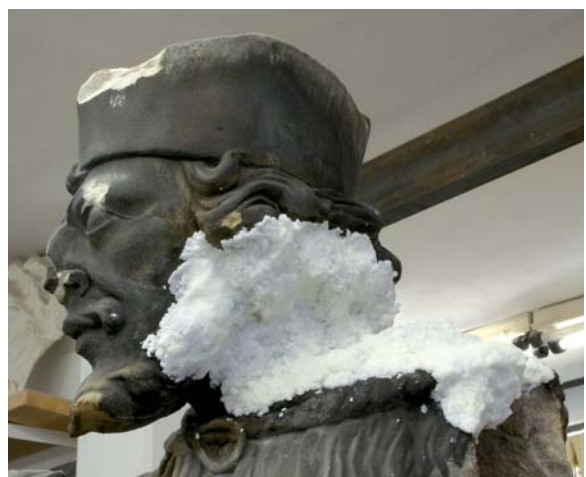
Obr. 47) Odsolovací arbocelový zábal s destilovanou vodou pro odsolení kamene po předchozím zábalu uhličitanem amonným.
