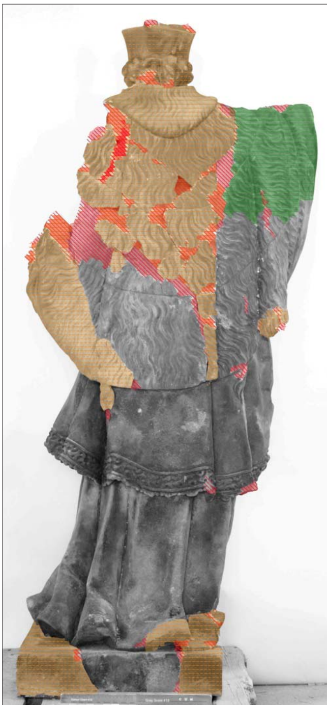
3) Zákres poškození na soše světce. Zadní pohled.
