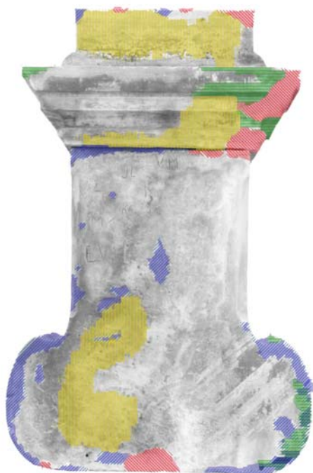
7) Zákres poškození na soklu. Zadní pohled.
