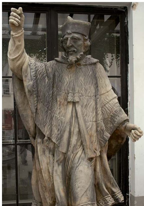
Obr. 60) Dolepené ruce po plastické retuši okolí doplňků z umělého kamene.
