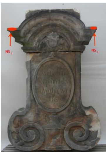
Obr. 3) a 4) Zákresy míst měření na soklu
