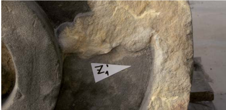
Obr. 94) Pozitivní výsledek zkoušky čištění od sádrovcových krust.
