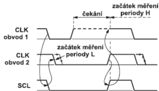
Obr. 1.04 Synchronizace hodin SCL [3]
