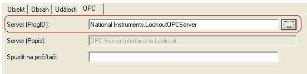
Obr. 15 – Nastavení OPC klienta – výběr OPC serveru
