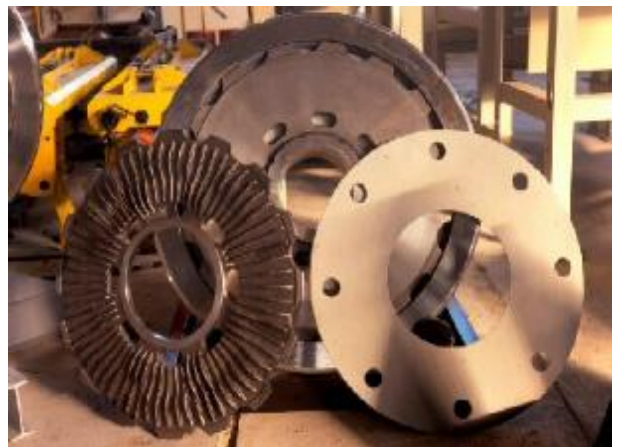
Obr. 10 Kolo s brzdovým kotoučem a tlumičem; zdroj Bonatrans
