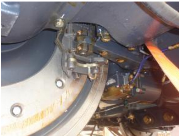
Obr. 9 Detail brzdy v podvozku, brzdové obložení Knorr-Bremse
