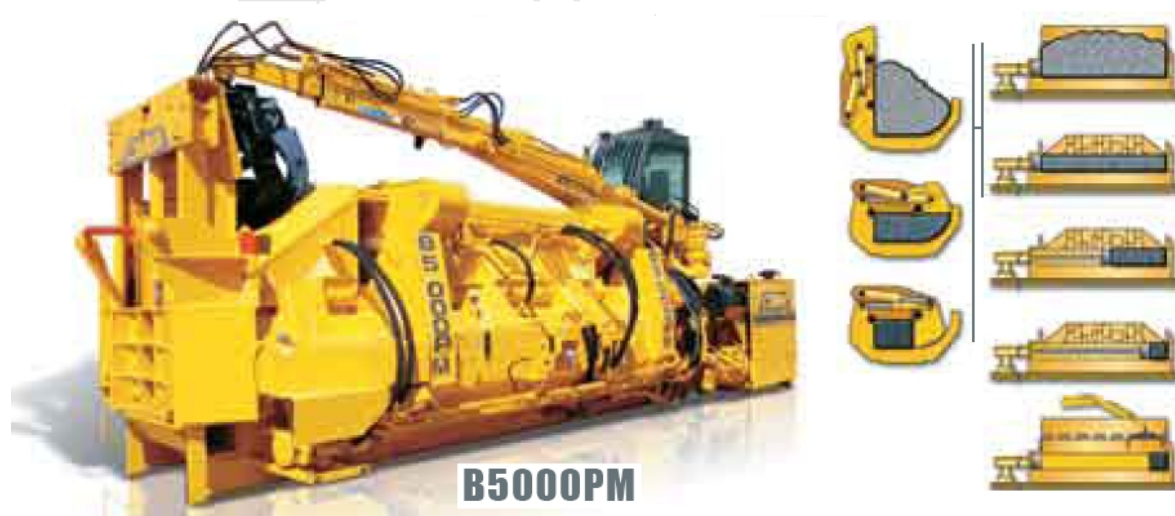
Obr. Lis COLMAR a princip lisovacího procesu [14]
