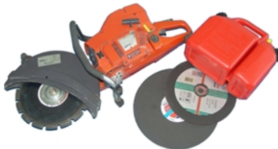
Obr. 3.14 Motorová kotoučová (rozbrušovací) pila [27]
