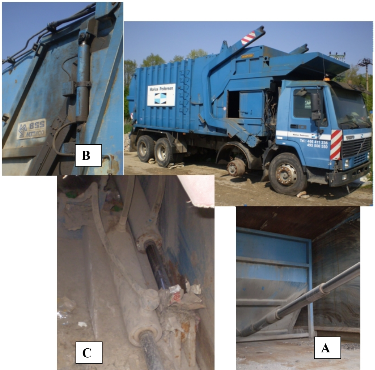
Obr. Vozidlo firmy Marius Pedersen a zobrazení hydraulických válců
