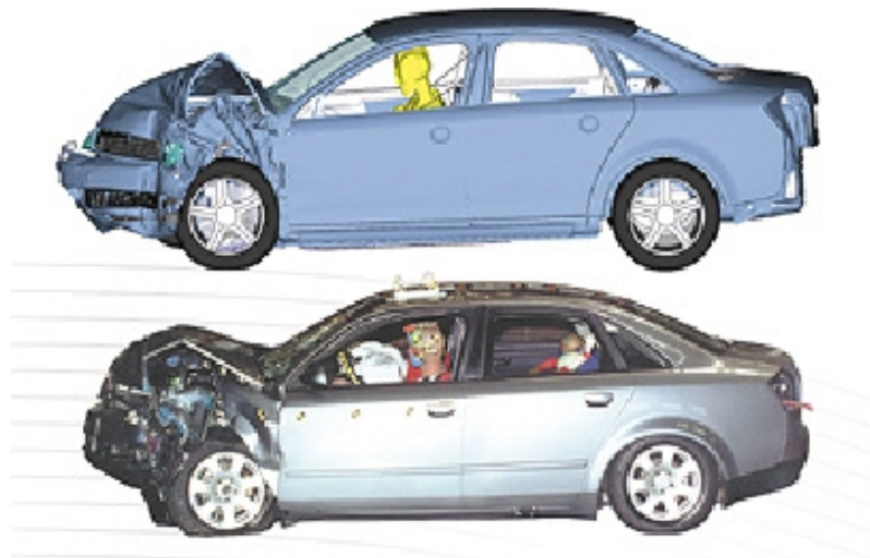
Obr. 4.2 Porovnání virtuálního nárazu a skutečného nárazu vozidla [39]
