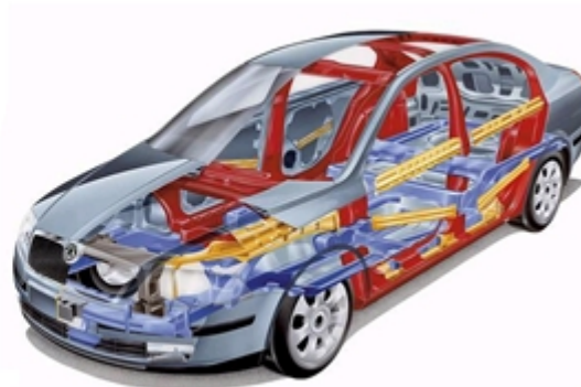
Obr. 3.3 Použití vysokopevnostních plechů na karosériích vozidel Škoda Fabia (vlevo) a Škoda Octavia poslední generace (vpravo) [32]
