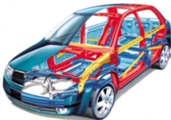
Obr. 3.3 Použití vysokopevnostních plechů na karosériích vozidel Škoda Fabia (vlevo) a Škoda Octavia poslední generace (vpravo) [32]
