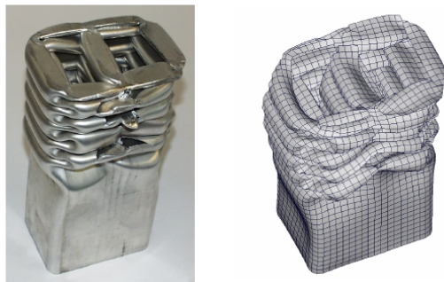
Obr. 4.4 Kvazistatické stlačení dvoukomorového hliníkového sloupce. Levý obrázek ukazuje experimentální výsledek. Pravý obrázek ukazuje odpovídající simulační výsledek [35]
