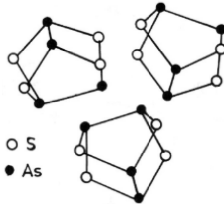
Obr. 6. Struktura jednotek realgarového typu \text{As}_4\text{S}_4 [16].
