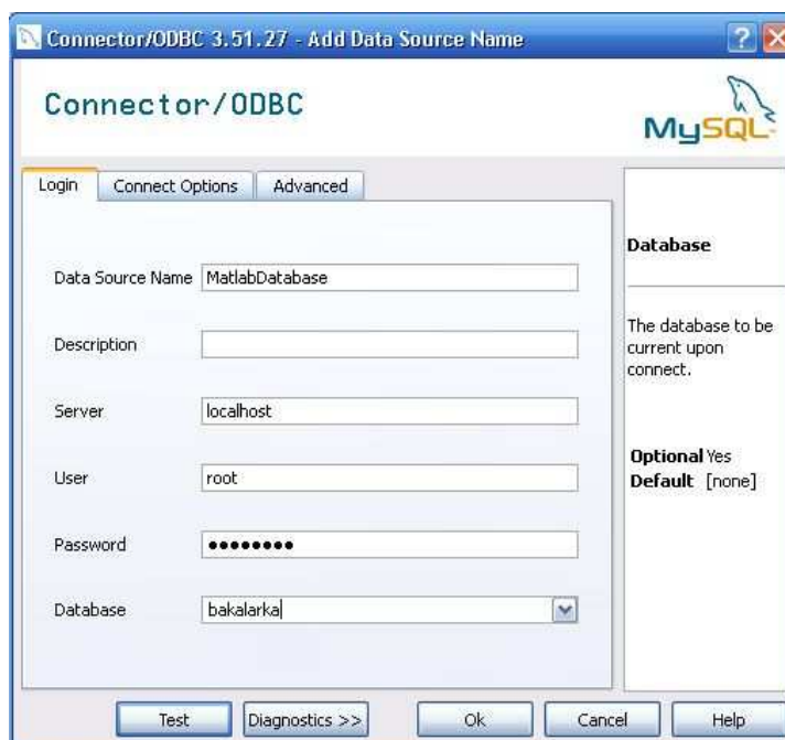
Obrázek 15 - Dialog pro nastavení zdrojů dat pomocí MySQL ODBC connector 3.51
