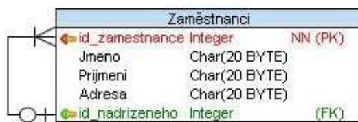
Obrázek 9 - Ukázka unárního spojení tabulky
