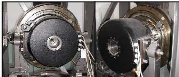
Obr.5.6 Detailní pohled na PMSM
