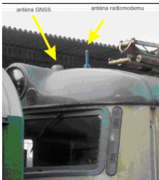
Obrázek č. 8: Antény zkušebního zařízení na lokomotivě
