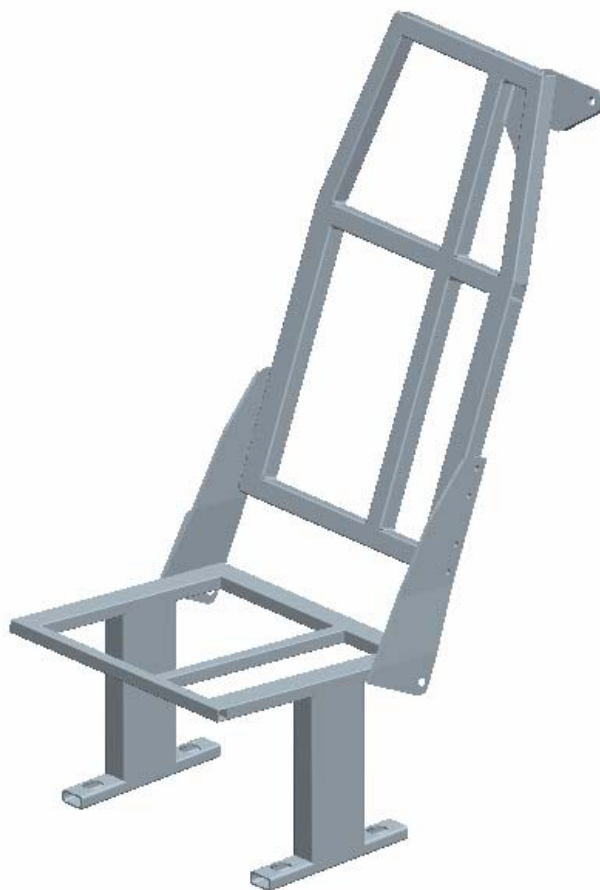
Obr.6.1 3D model konstrukce sedadla.
