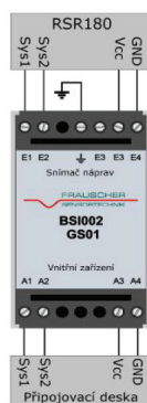
Obrázek 36: Zapojení přepětové ochrany BSI [5]
