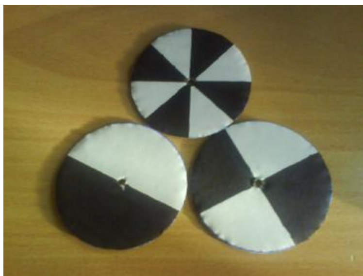
Obr 4.03 – Kotouče pro měření reflexních závor
