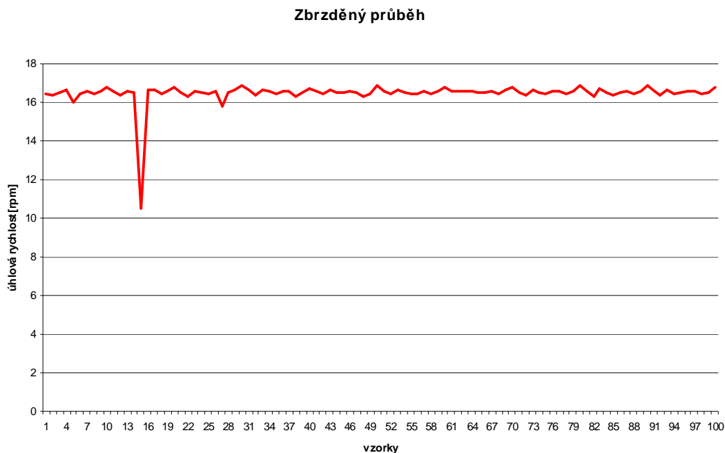
Obr 5.04 – Měření při zbrzdění kotouče
