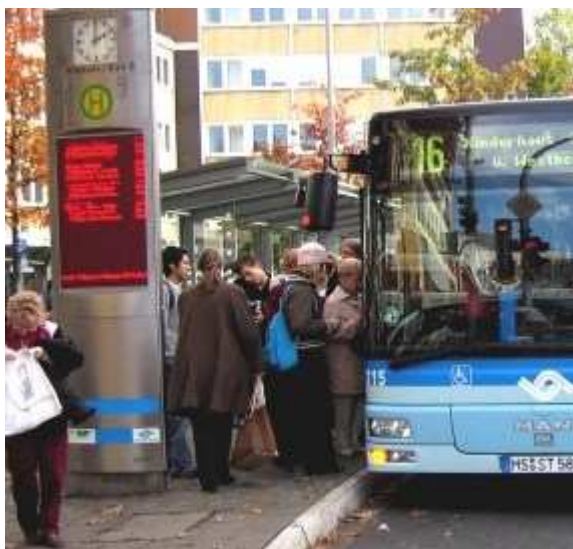
Obrázek 19 - Moderní zastávkový sloupek s on-line informacemi o příjezdu spoje (Münster)
