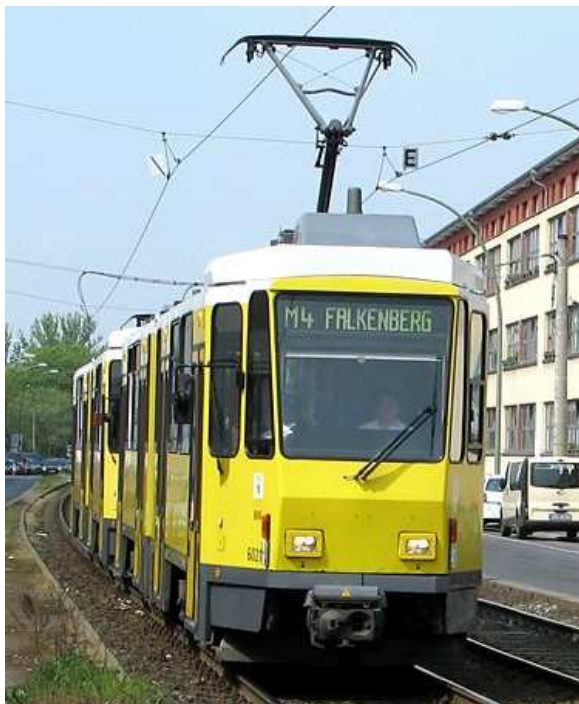
Obrázek 25 - Tramvaj české výroby typu KT4D na berlínské lince systému MetroTram M4 s viditelným linkovým označením
