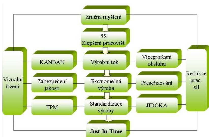
Obrázek 4: Implementace metod při budování JIT
