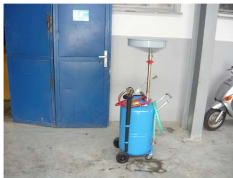
Obr. č. 7: Jímka na použitý olej
