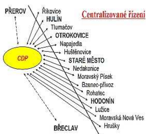
Obrázek 2: Schéma centralizovaného řízení
