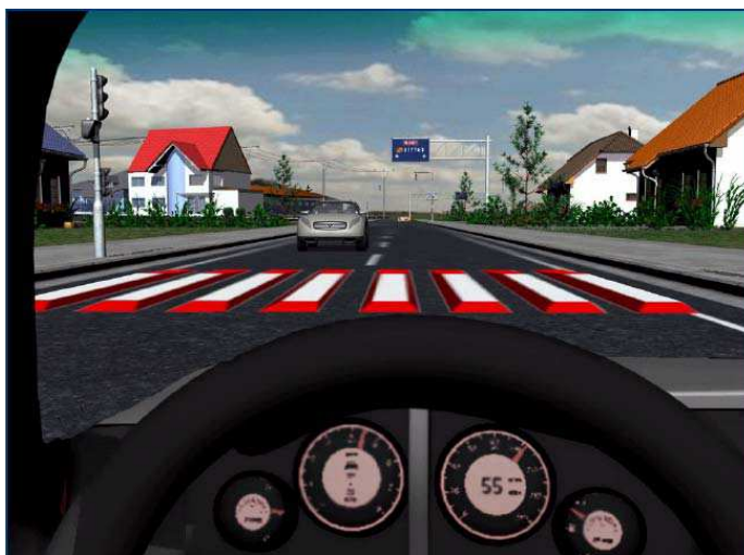
Obrázek 8 - 3D zvýraznění přechodu pro chodce Zdroj: (8)
