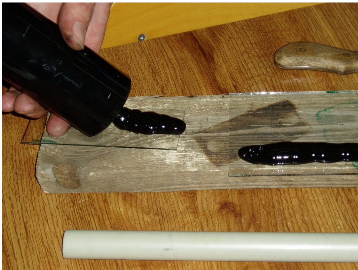
Obrázek 18: Vytlačování lepidla na skleněnou podložku
