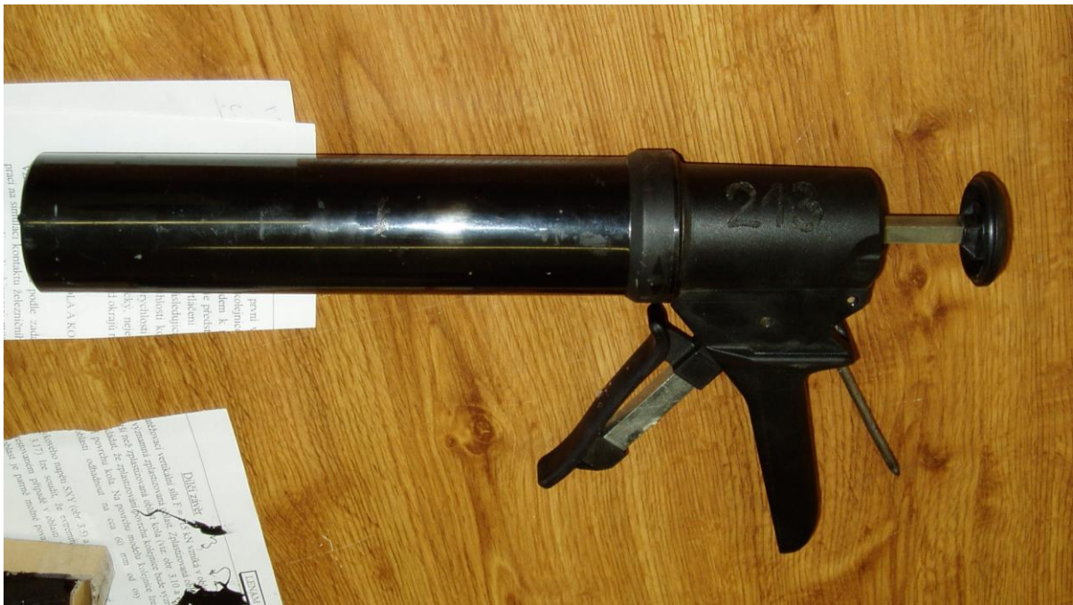
Obrázek 6: Pistole pro vytlačení lepidla z kartuše
