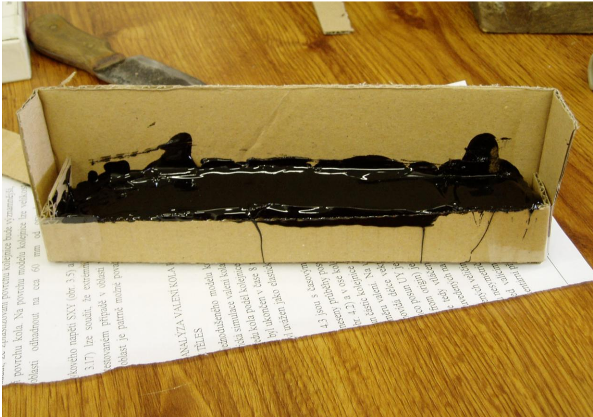
Obrázek 11: Příprava forem pro zkoušené lepidlo – čtvercový profil
