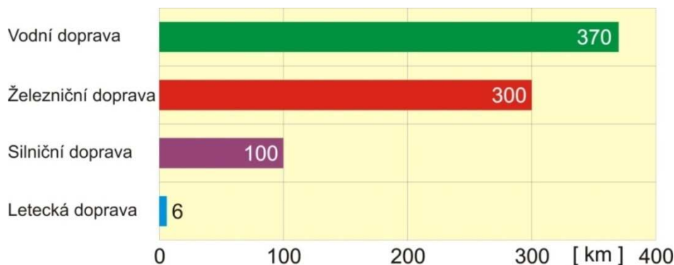
Obrázek 1 – Závislost vzdálenosti přepravy 1 tuny zboží při stejné spotřebě energie Zdroj: [1]
