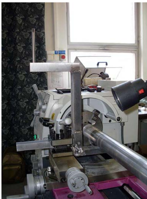
Obr. 5.4: Přípravek pro uchycení testovaného vzorku připevněný na soustruhu
