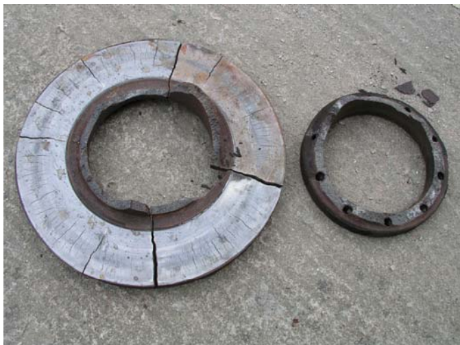
Obr. 4.2: Rozlomený brzdový kotouč a detail trhlín na jeho povrchu (dole)
