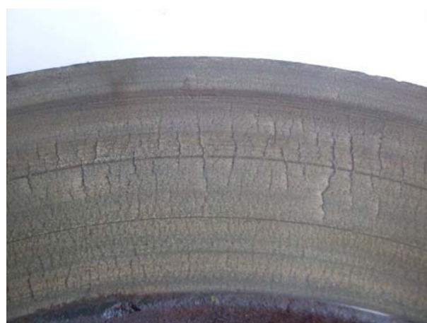
Obr. 4.2: Rozlomený brzdový kotouč a detail trhlín na jeho povrchu (dole)
