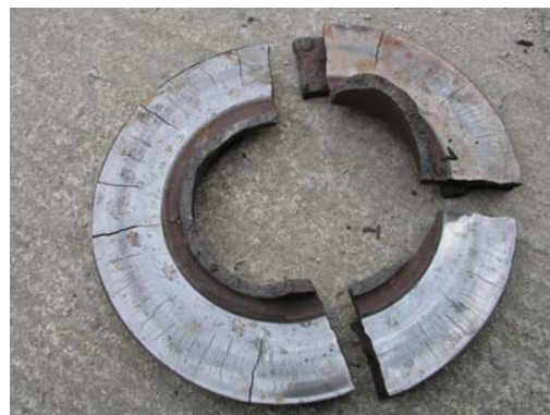
Obr. 4.2: Rozlomený brzdový kotouč a detail trhlín na jeho povrchu (dole)
