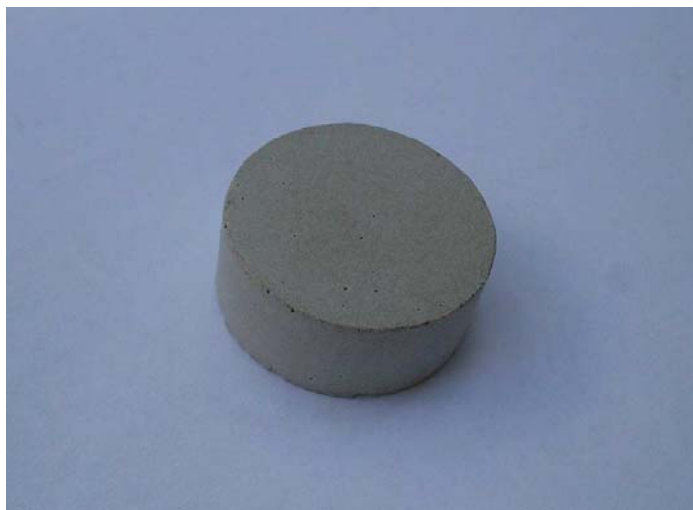
Obr. 5.2: Testované vzorky geopolymery ve tvaru válečku
