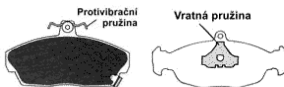
Obr. 3.3: Umístění protivibrační a vratné pružiny na opěrné desce [18]
