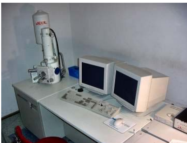
Obr. 4.9: Skenovací elektronový mikroskop JEOL JSM-5500LV s počítačovým příslušenstvím
